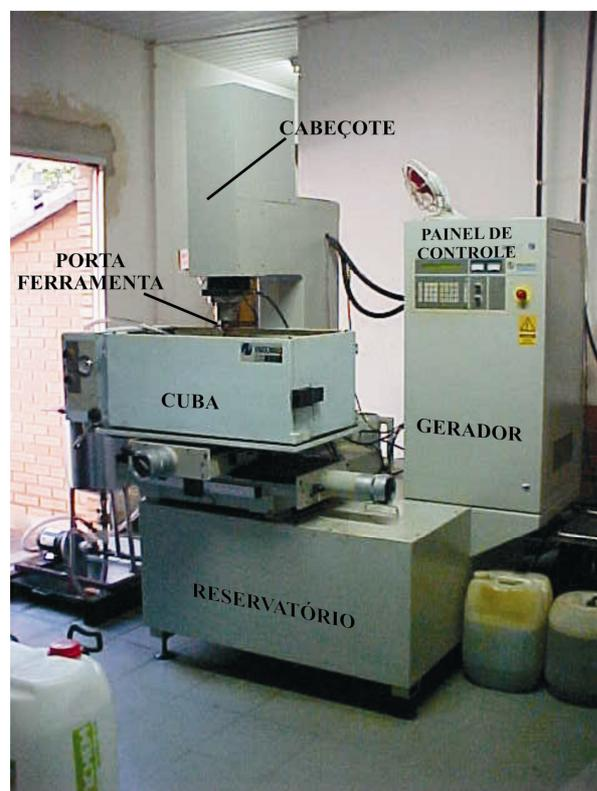
Figura 4.2. Equipamento EDM por penetração.
