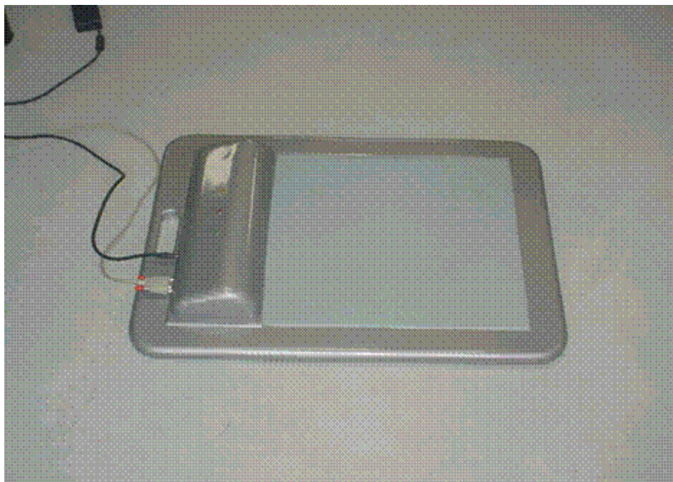
FIGURA 5: Plataforma de força - Placa Barosensível de Dimensões Variadas, com Sensores Piezoelétricos.
