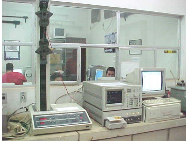
Figura 3.28 - Montagem do sistema de monitoramento de impedância durante ensaios de tração.
