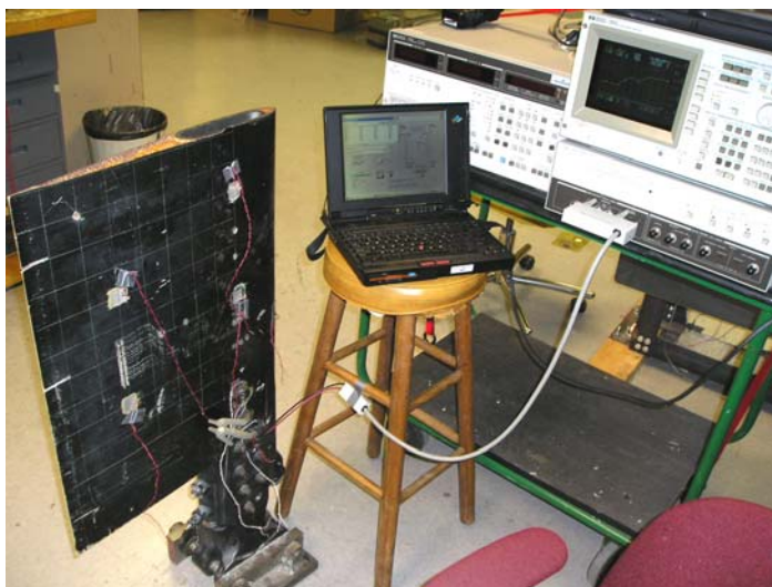
Figura 8.42 - Aparato experimental para ensaios com a pá de aplicação militar.
