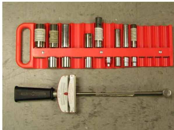
Figura 3.2 - Torquímetro utilizado durante o experimento de junção por flanges
