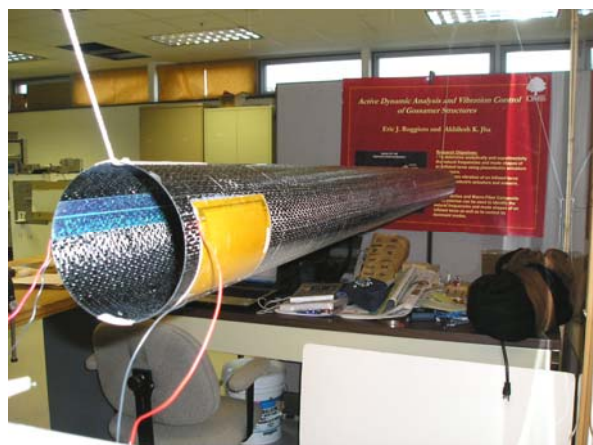
b) Pastilha MFC colada na estrutura
