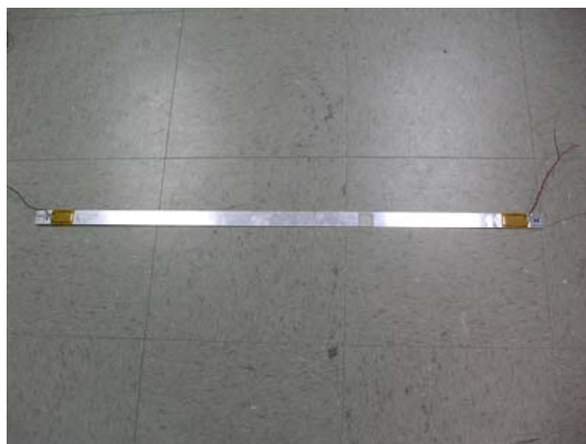
a) Viga de alumínio com as pastilhas MFC coladas
