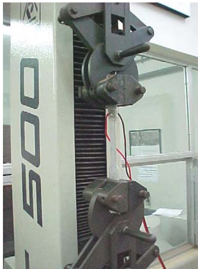
Figura 3.26 - Máquina de ensaios de tração e corpo de prova em condições de teste
