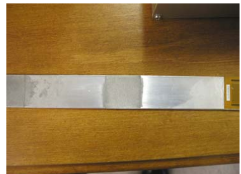
b) Exemplo de corrosão leve
