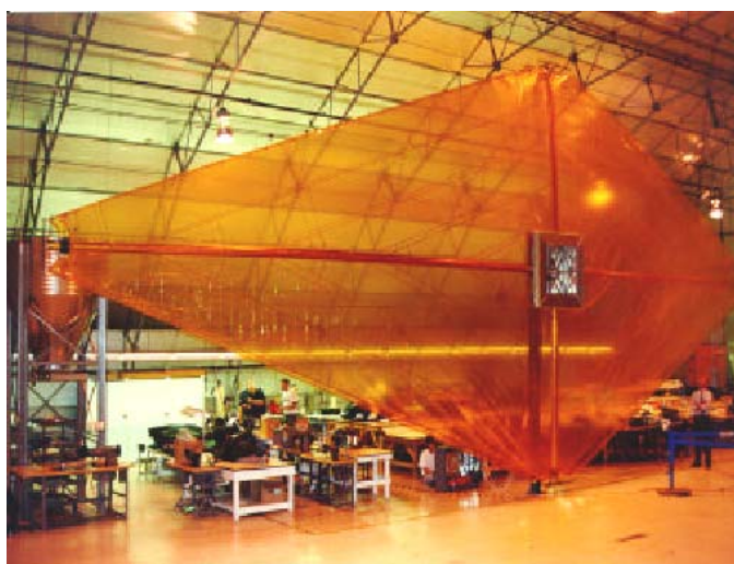
Figura 7.4 - Modelo de meia escala do projeto ISIS (Sapna et al , 2000).
