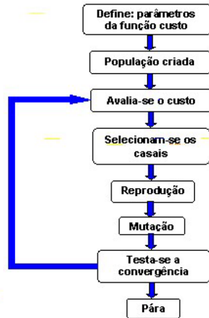
Figura 2.38 - Fluxograma simplificado de um AG com parâmetros contínuos.
