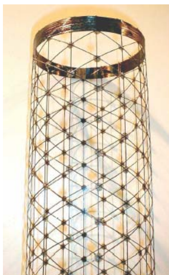
Figura 7.3 - Tubo enrijecedor ultraleve para estruturas Gossamer (Lin et al , 2002).
