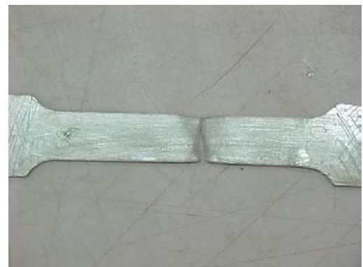
b) detalhe sobre a ruptura dúctil do corpo de prova
