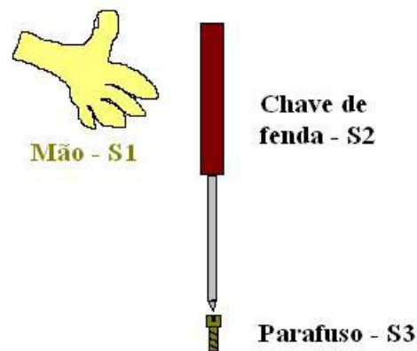
Figura 2.34 - Exemplo de uma análise C-S de um aperto de parafuso
