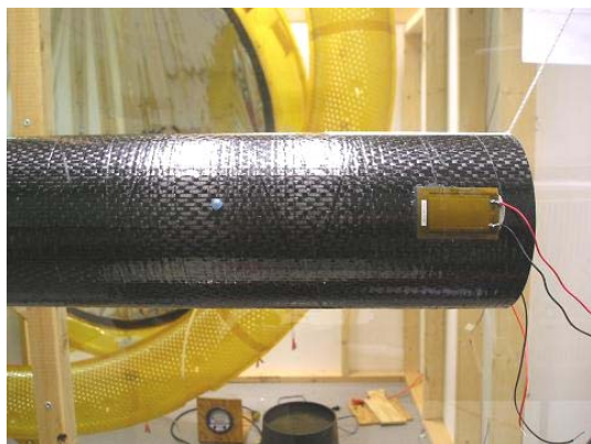
a) MFC 1 utilizado no monitoramento
