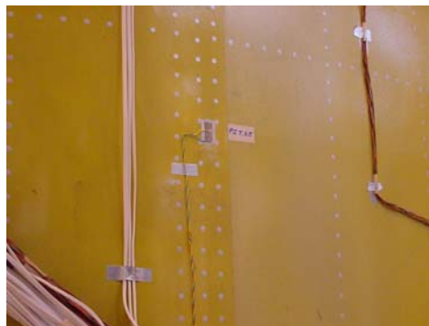
Figura 6.7 - Estrutura tipo “barril” de uma aeronave comercial com uma pastilha de PZT colada em sua superfície.
