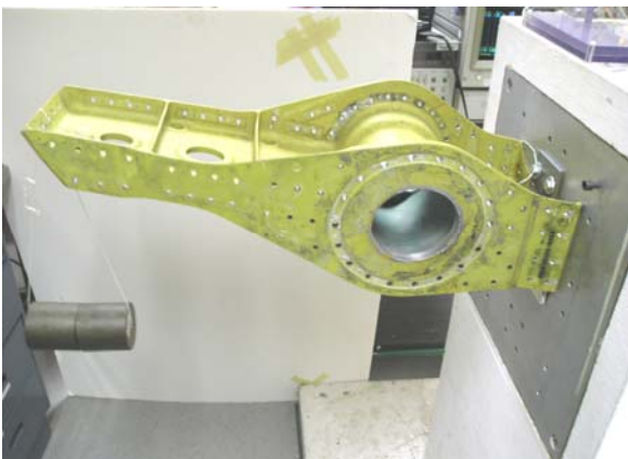
a) Pilone como uma “viga em balanço”
