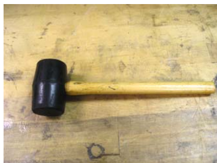
Figura 8.41 - Martelo de impacto para excitar a estrutura.
