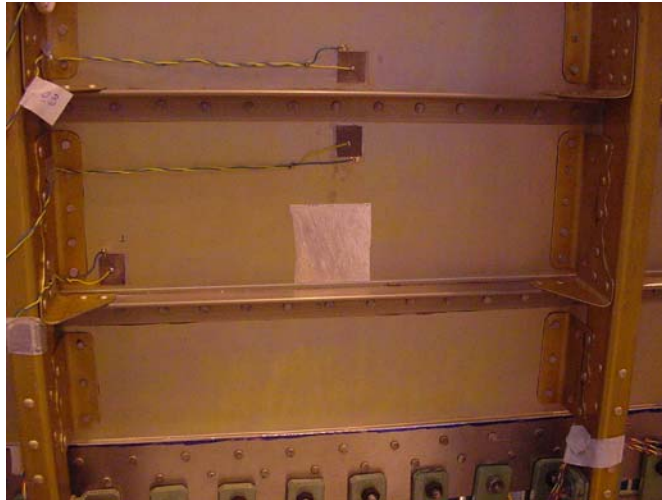
Figura 6.22 - Ensaio inicial com adição de massa feita apenas com uma fita de alumínio.
