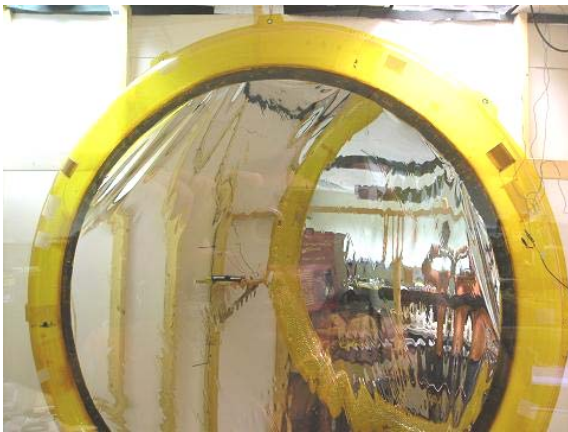
a) Satélite com as pastilhas MFC nas bordas
