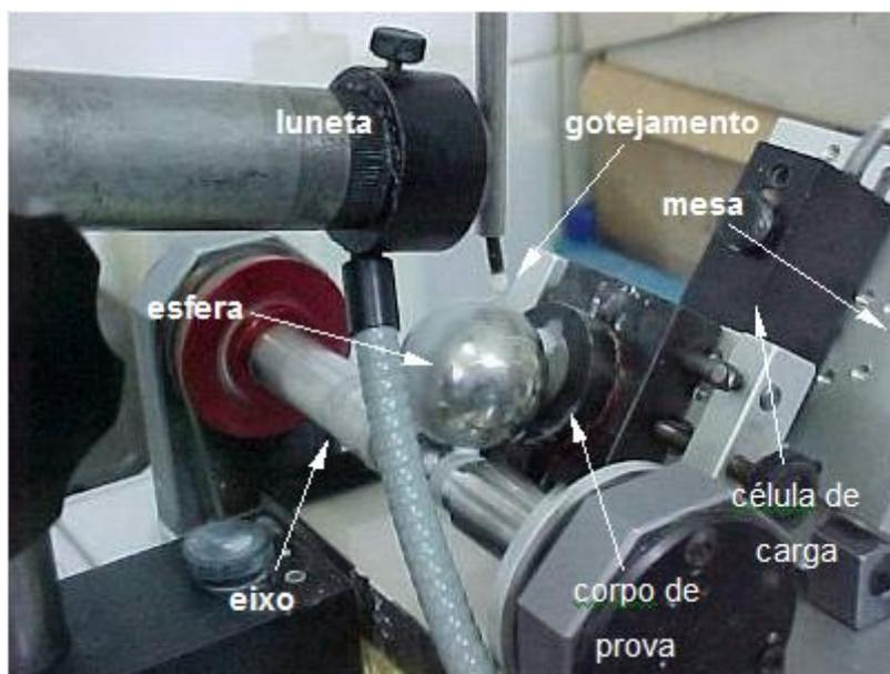
Figura 3.14 - máquina de ensaio de desgaste por microabrasão, configuração esfera livre.
