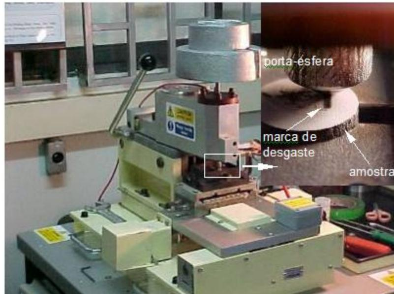
Figura 3.5 - Tribômetro universal no modo alternado com a carga do ensaio já montada e no canto superior direito destaca-se a formação da marca de desgaste na amostra.
