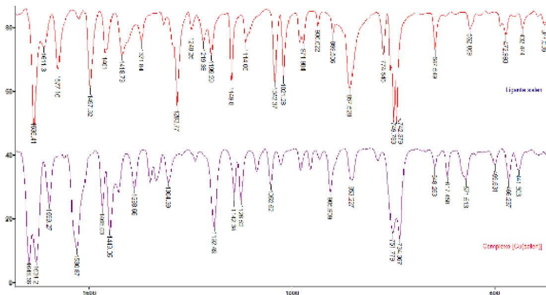
FIGURA 4.4. Espectro vibracional (Transmitância x Número de onda  $\text{cm}^{-1}$ ) na região do infravermelho entre 1700 e 350  $\text{cm}^{-1}$  para o ligante salen juntamente com seu respectivo complexo de cobre.
