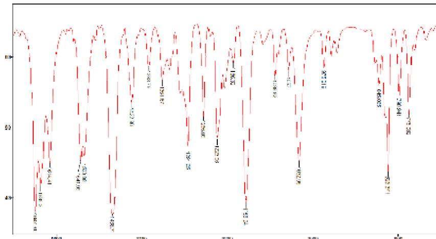
FIGURA 4.2. Espectro vibracional (Transmitância x Número de onda  $\text{cm}^{-1}$ ) ilustrativo da grande quantidade de bandas presentes na região entre  $1700\text{-}600\text{ cm}^{-1}$  nos compostos apresentados.
