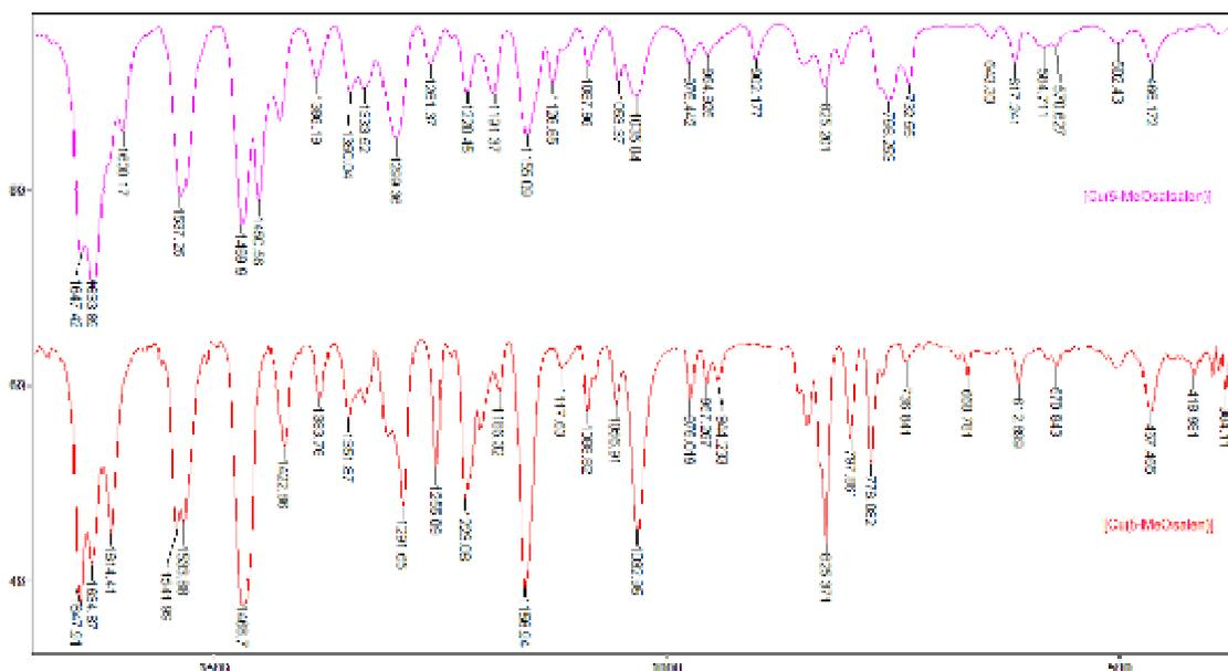
FIGURA 4.81. Espectro vibracional (Transmitância x Número de onda  $\text{cm}^{-1}$ ), na região do infravermelho para o complexo assimétrico com substituinte metoxi na posição 5 em comparação com o complexo similar simétrico.
