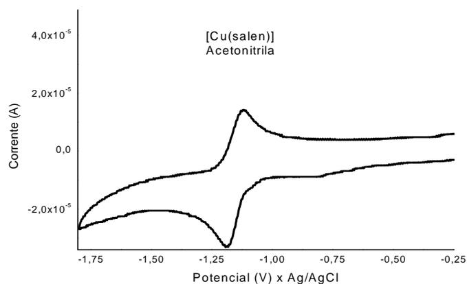
FIGURA 4.6. Voltamograma cíclico obtido com eletrodo de carbono vítreo em solução  $1,0 \times 10^{-3} \text{ mol.L}^{-1}$  do complexo [Cu(salen)] em acetonitrila, contendo  $0,1 \text{ mol.L}^{-1}$  de PTBA. Velocidade de varredura de  $0,1 \text{ V/s}$ .
