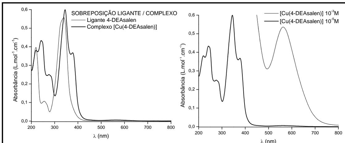
FIGURA 4.35. Espectros eletrônicos na região do ultravioleta-visível, para o ligante 4-DEAsalen com seu respectivo complexo de cobre.
