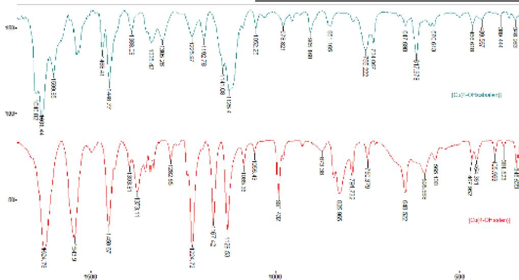
FIGURA 4.77. Espectro vibracional (Transmitância x Número de onda  $\text{cm}^{-1}$ ), na região do infravermelho para o complexo assimétrico com substituinte hidroxila na posição 4 em comparação com o complexo correspondente simétrico.
