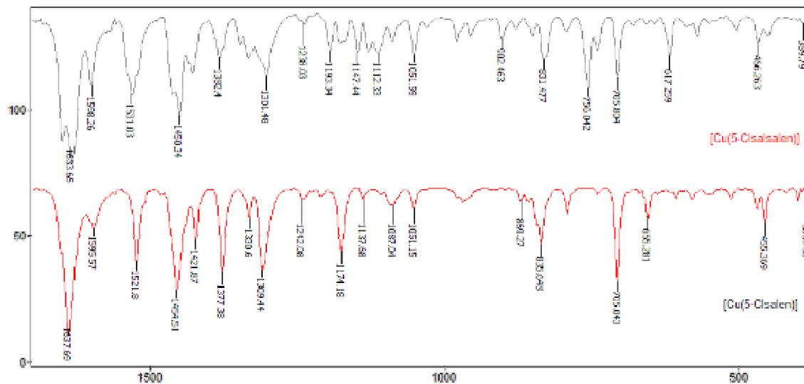
FIGURA 4.83. Espectro vibracional (Transmitância x Número de onda  $\text{cm}^{-1}$ ), na região do infravermelho para o complexo assimétrico com substituinte cloro na posição 5 em comparação com o complexo similar simétrico.
