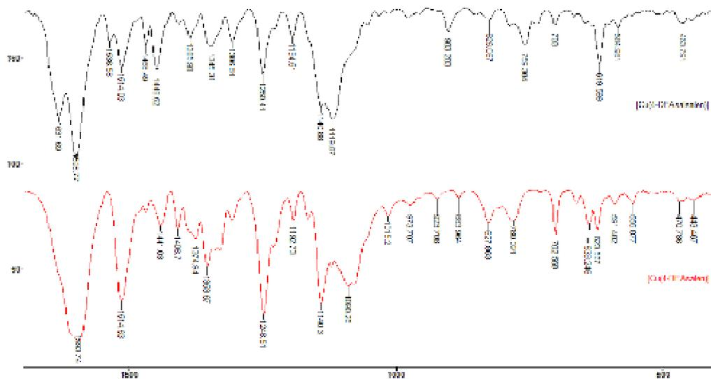
FIGURA 4.78. Espectro vibracional (Transmitância x Número de onda  $\text{cm}^{-1}$ ), na região do infravermelho para o complexo assimétrico com substituinte dietilamina na posição 4 em comparação com o complexo correspondente simétrico.
