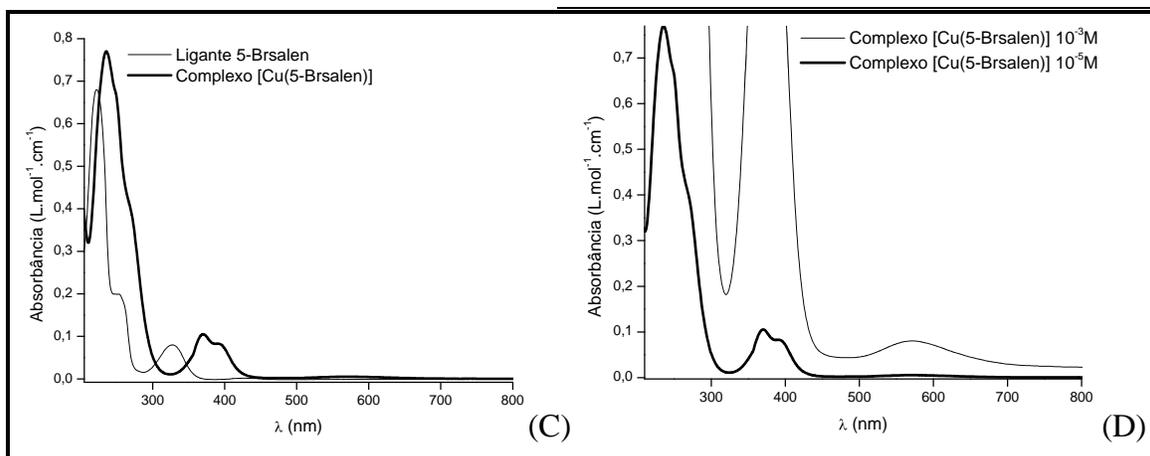
FIGURA 4.46. Espectros eletrônicos na região do ultravioleta-visível, para os ligantes com seus respectivos complexos de cobre.
