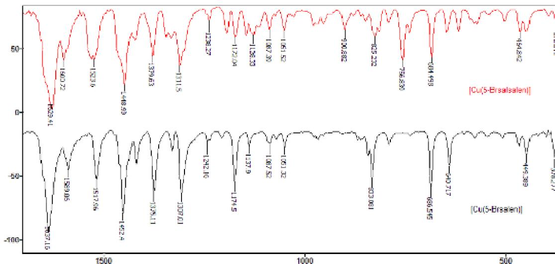
FIGURA 4.84. Espectro vibracional (Transmitância x Número de onda  $\text{cm}^{-1}$ ), na região do infravermelho para o complexo assimétrico com substituinte bromo na posição 5 em comparação com o complexo similar simétrico.
