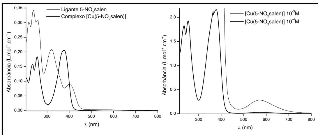
FIGURA 4.42. Espectros eletrônicos na região do ultravioleta-visível, para o ligante 5-NO<sub>2</sub>salen com seu respectivo complexo de cobre.
