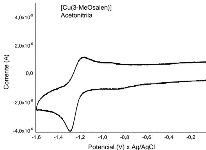
FIGURA 4.16. Voltamograma cíclico obtido com eletrodo de carbono vítreo em solução  $1,0 \times 10^{-3} \text{ mol.L}^{-1}$  do complexo  $[\text{Cu}(3\text{-MeOsalen})]$  em acetonitrila, contendo  $0,1 \text{ mol.L}^{-1}$  de PTBA. Velocidade de varredura de  $0,1 \text{ V/s}$ .
