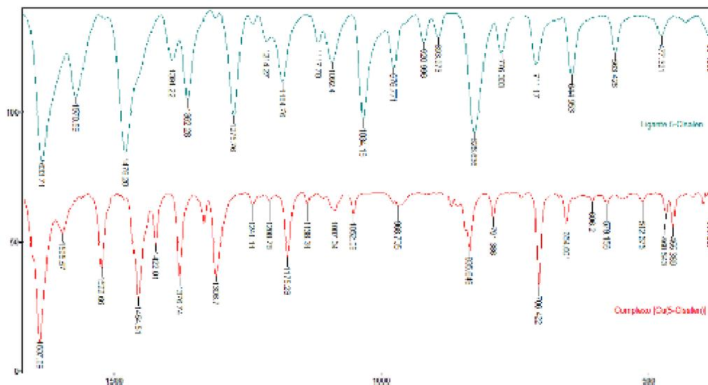
FIGURA 4.44. Espectros vibracionais (Transmitância x Número de onda cm<sup>-1</sup>) na região do infravermelho para o ligante 5-Clsalen com seu respectivo complexo.
