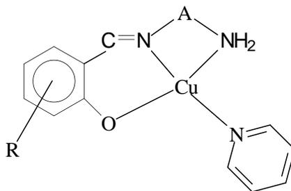
FIGURA 2.3. Estrutura das bases de Schiff tridentadas, onde R = substituinte que pode ocupar as posições 3, 4, 5 e 3,5 do anel aromático e A = CH<sub>2</sub>CH<sub>2</sub>; C<sub>6</sub>H<sub>10</sub> ou C<sub>6</sub>H<sub>4</sub>.
