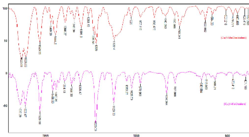
FIGURA 4.76. Espectro vibracional (Transmitância x Número de onda  $\text{cm}^{-1}$ ), na região do infravermelho para o complexo assimétrico com substituinte metoxi na posição 4 em comparação com o complexo correspondente simétrico.
