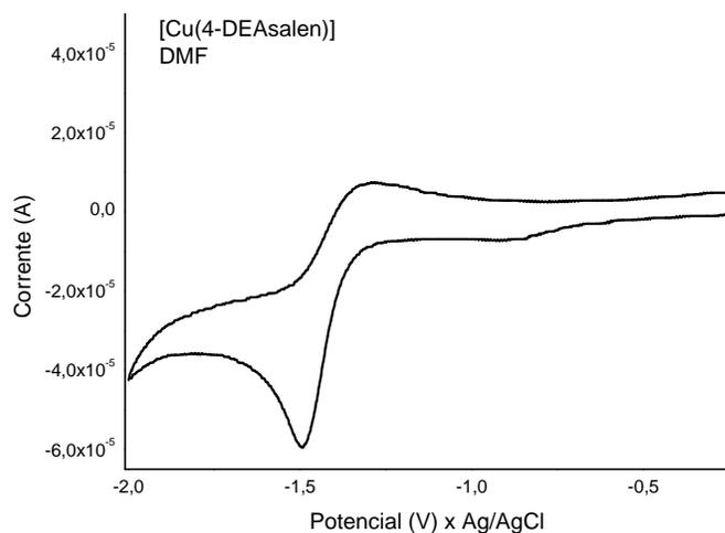
FIGURA 4.36. Voltamograma cíclico obtido com eletrodo de carbono vítreo em solução  $1,0 \times 10^{-3} \text{ mol.L}^{-1}$  do complexo  $[\text{Cu}(4\text{-DEAsalen})]$  em DMF, contendo  $0,1 \text{ mol.L}^{-1}$  de PTBA. Velocidade de varredura de  $0,1 \text{ V/s}$ .
