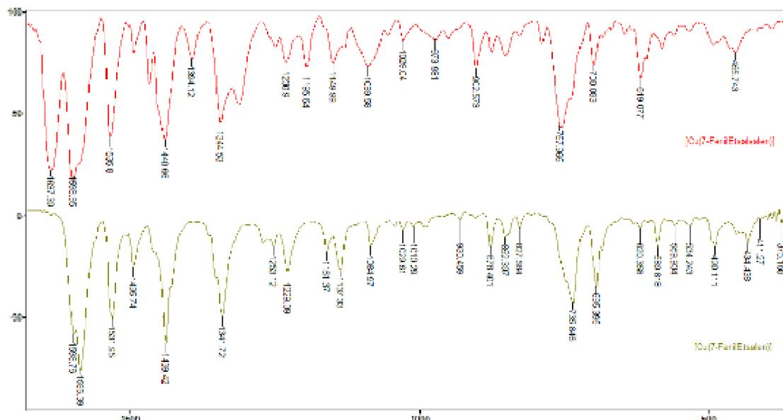
FIGURA 4.94. Espectro vibracional (Transmitância x Número de onda  $\text{cm}^{-1}$ ), na região do infravermelho comparando o complexo assimétrico com substituinte feniletíl na posição 7 e seu correspondente complexo simétrico.
