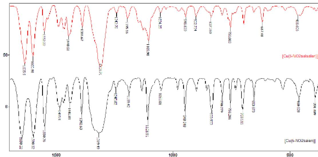
FIGURA 4.82. Espectro vibracional (Transmitância x Número de onda  $\text{cm}^{-1}$ ), na região do infravermelho para o complexo assimétrico com substituinte nitro na posição 5 em comparação com o complexo similar simétrico.
