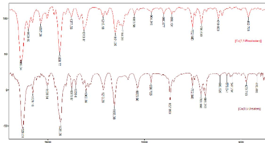
FIGURA 4.88. Espectro vibracional (Transmitância x Número de onda  $\text{cm}^{-1}$ ), na região do infravermelho comparando o complexo assimétrico com substituintes 3,5-Br e o correspondente complexo simétrico.
