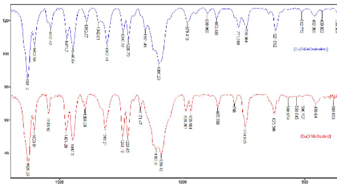
FIGURA 4.72. Espectro vibracional (Transmitância x Número de onda  $cm^{-1}$ ), na região do infravermelho para o complexo assimétrico com substituinte metoxi na posição 3 em comparação o correspondente complexo simétrico.
