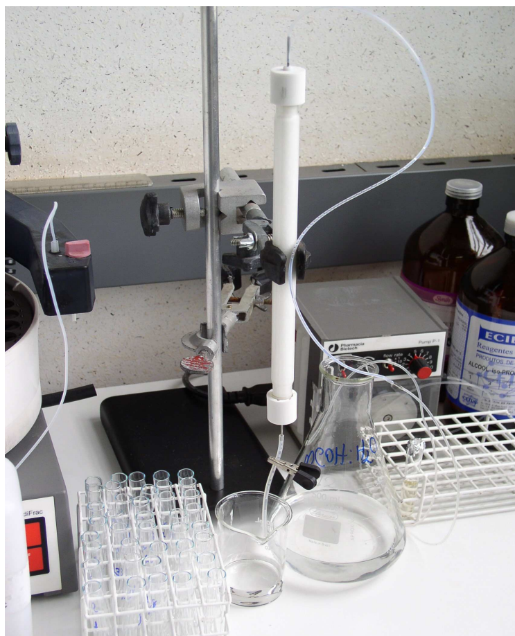
Figura 6: Sistema de fracionamento montado com a coluna LOBAR ® e bomba peristáltica.
