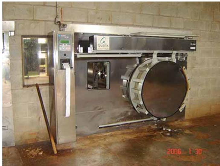
Ilustração 5 - Autoclave para tratamento dos resíduos biológicos em um aterro sanitário
