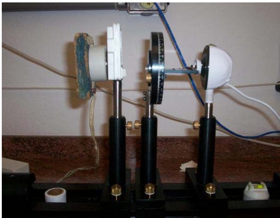
Figura 2 - Aparato experimental utilizado para as medidas de ângulo de contato.
