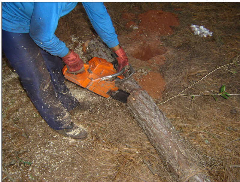
FIGURA 5 - SECCIONAMENTO DO TRONCO EM DISCOS
