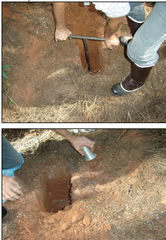
FIGURA 6 - AMOSTRAGEM PARA COLETA DE SOLO PARA ANÁLISES QUÍMICAS (ACIMA) E FÍSICAS (ABAIXO)
