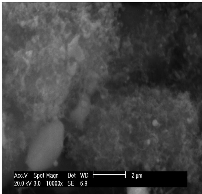
**Figura 4.22** - Micrografia eletrônica de Varredura para amostra de  $\text{CeO}_2/\text{Co}_3\text{O}_4$  calcinado a  $700\text{ }^\circ\text{C}/2\text{ h}$ , obtidos por método de gel-Combustão.
