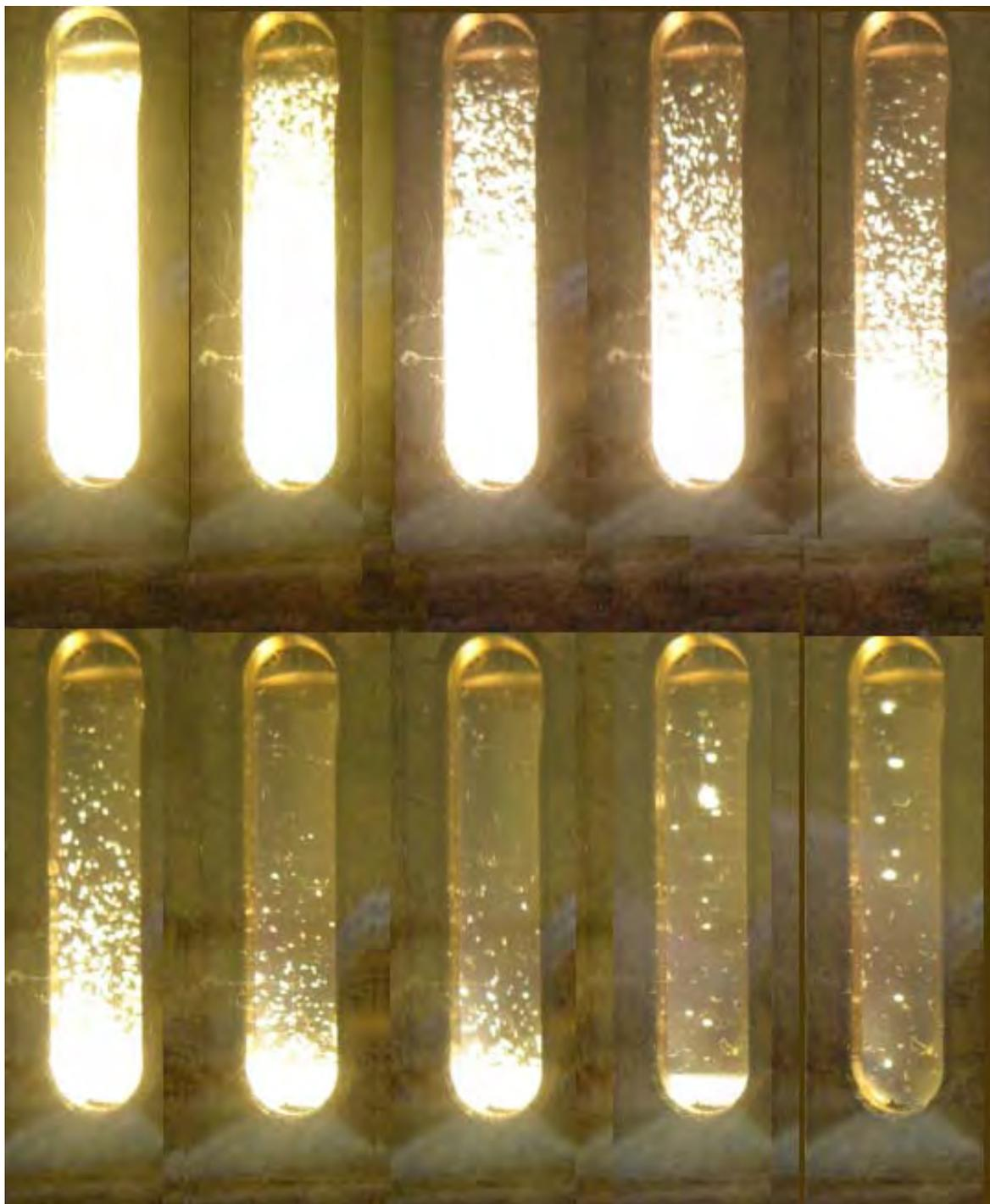
**Figura 3.2-** Seqüência de fotos mostrando a evolução de uma transição de fases, da fase micelar lamelar ( $L_D$ ) (canto superior esquerdo) para a fase micelar isotrópica (I) (canto inferior direito), durante aquecimento. As regiões intermediárias são regiões bifásicas onde as fases  $L_D$  e I coexistem simultaneamente. Concentração da amostra:  $W_A = 52,0\%$  APFO.
