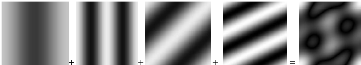
Figura 4. Formação de imagem pela soma de ondas periódicas e não-periódicas (Fonte: Disponível em http://www.vision.ime.usp.br/~creativision/seminars/files/2004/09_17-zana.pdf . Acessado e modificado em novembro de 2006).
