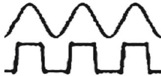
Figura 7. A amplitude da freqüência fundamental de uma onda senóide formadora de uma onda quadrada (em cima) é 4/\pi maior que a amplitude do padrão de onda quadrada (em baixo) (Fonte: Disponível em http://www.vision.ime.usp.br/~creativision/seminars/files/2004/09_17-zana.pdf . Acessado e modificado em novembro de 2006).
