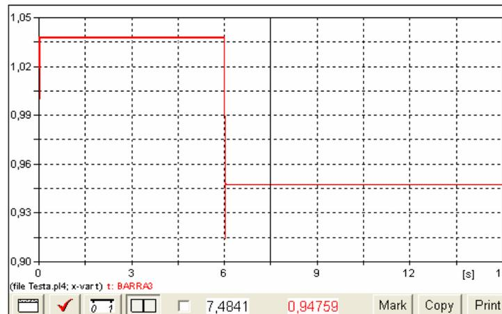
Figura 4.5- Tensão na barra 3 mediante a abertura da linha
