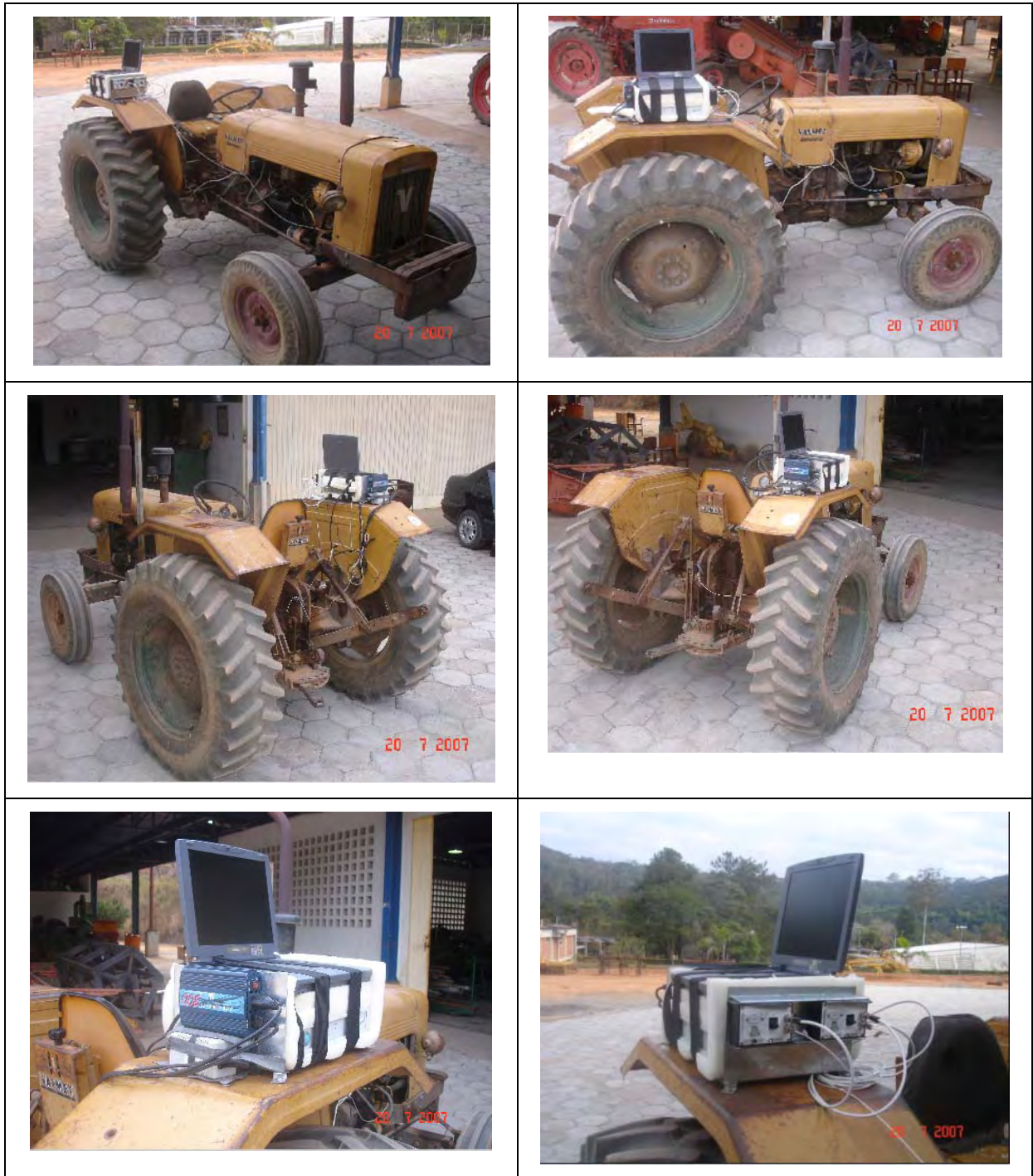
Figura D.1- Fotografias do trator equipado com o sistema de aquisição de dados
