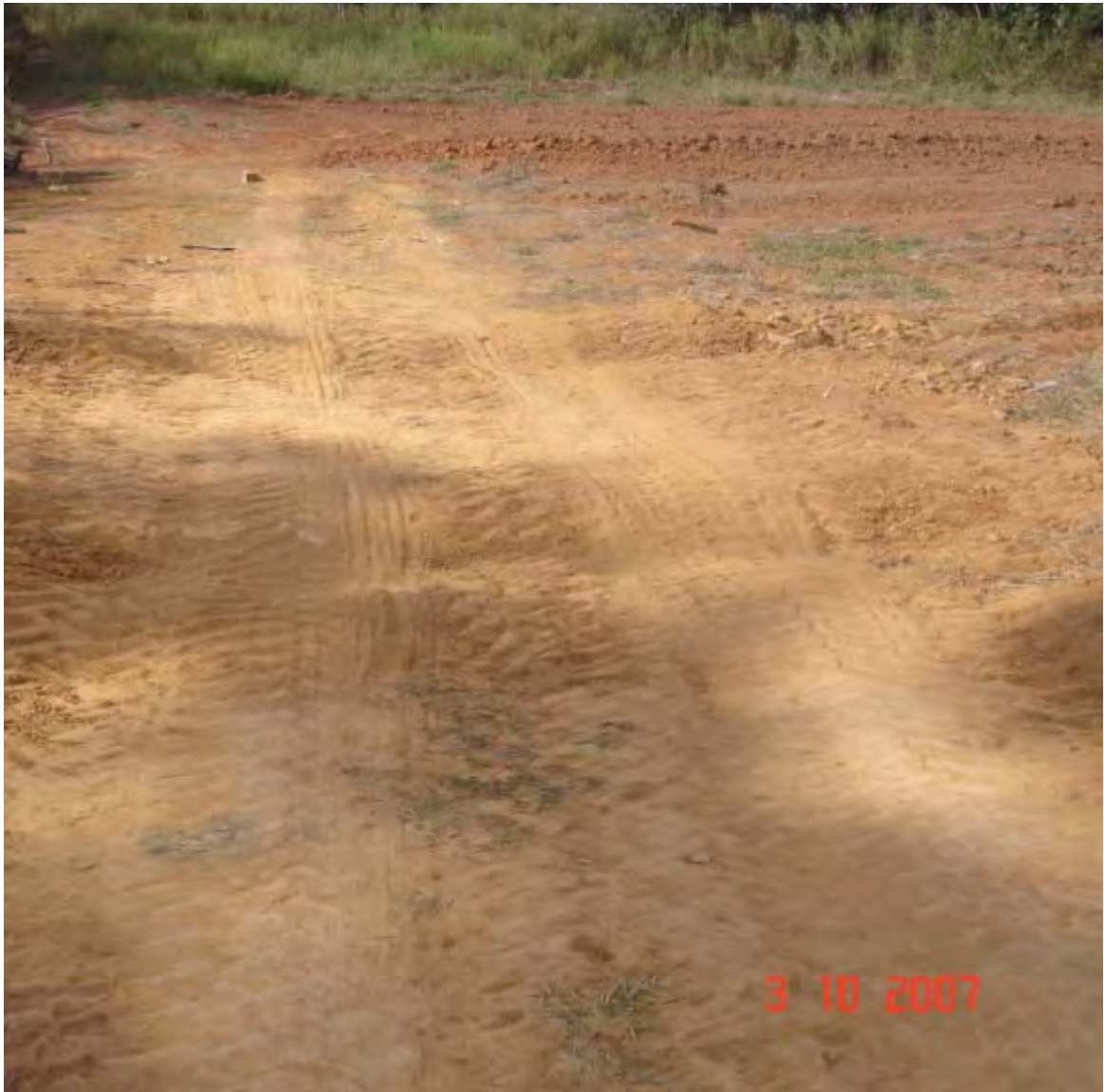
Figura C.1 - Fotografia da pista de prova com depressão dupla utilizada no teste de campo (obstáculo C).
