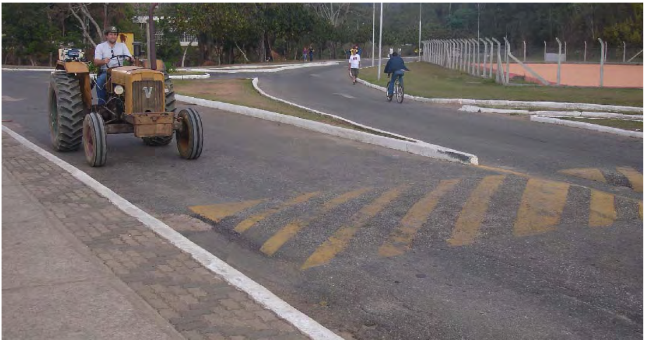
Figura C.3 - Fotografia da pista de prova com lombada simples (obstáculo A).
