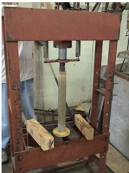
FIGURA 3.8 – Desmoldagem dos perfis.
