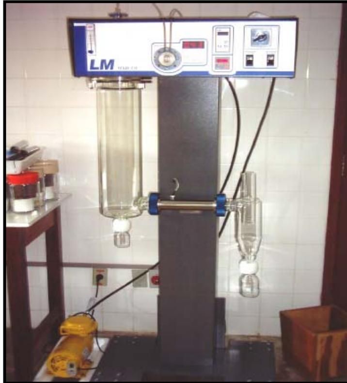
**Figura 3.2** - Secador por aspersão (Labmaq MSD 1.0)
