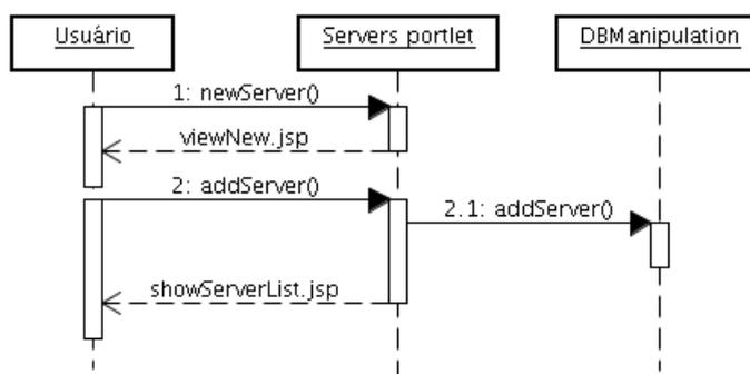
Figura 4.16: Diagrama de sequência de inserção de servidores
