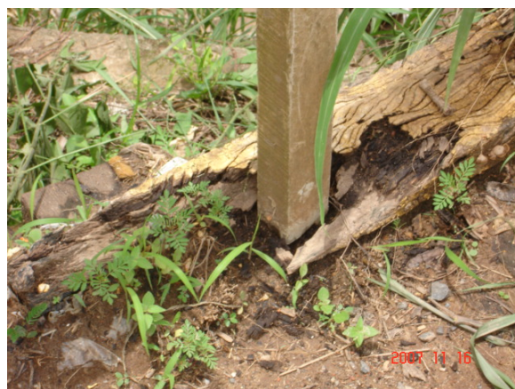
Figura 6.28 – Avançado grau de apodrecimento da madeira
