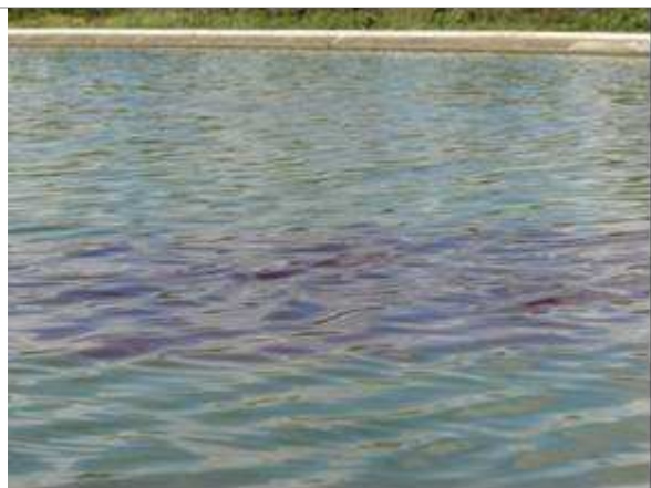
Figura 5.5 Corante na superfície da lagoa no primeiro experimento, sem camada de lodo.
