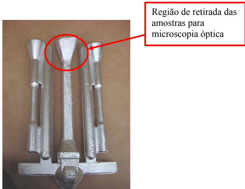
Figura 86 – Corpos-de-prova obtidos com o uso da coquilha segundo norma ASTM B108 indicando a região de onde foram retiradas as amostras para observação metalográfica.
