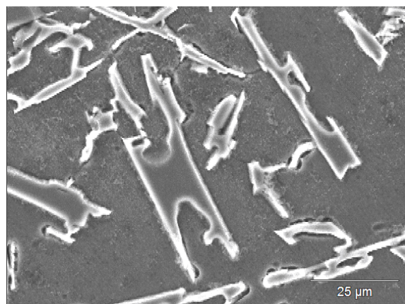
(a) Liga 7 (0 ppm Sr) – Partículas de silício acicular (não modificado).
