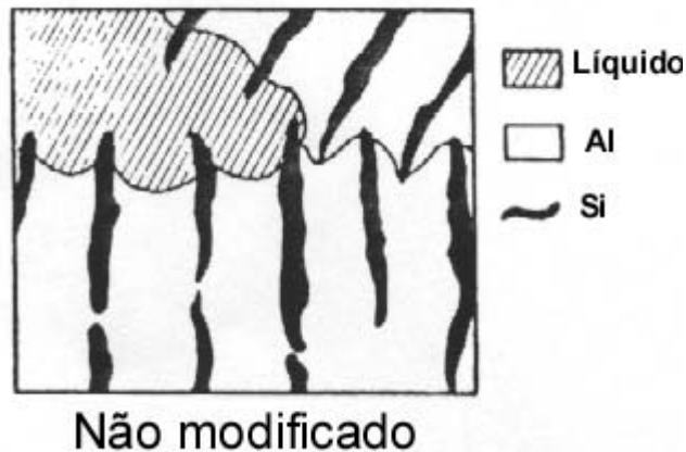
Figura 41 – Eutético Al-Si não modificado com o silício liderando o crescimento e cristais de silício interpenetrando os contornos de células eutéticas. 23
