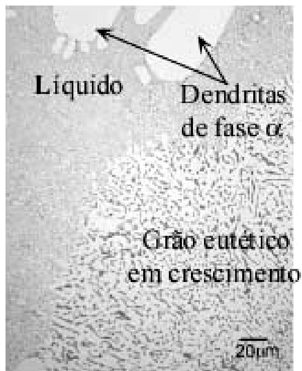
Figura 21 – Liga Al-Si congelada durante a solidificação das células eutéticas, apresentando dendritas de alumínio e uma célula eutética em crescimento. 47
