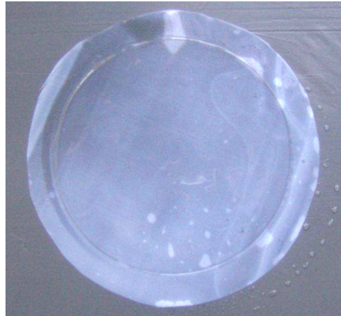
Figura 58 – Membrana porosa CP/P3(HB-22%HV) formulada por inversão de fase.
