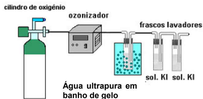
Figura 4.3. Sistema de ozonização de água ultrapura utilizando O_2/O_3 , sob resfriamento (em banho de gelo) a aproximadamente 4^\circ\text{C} .
