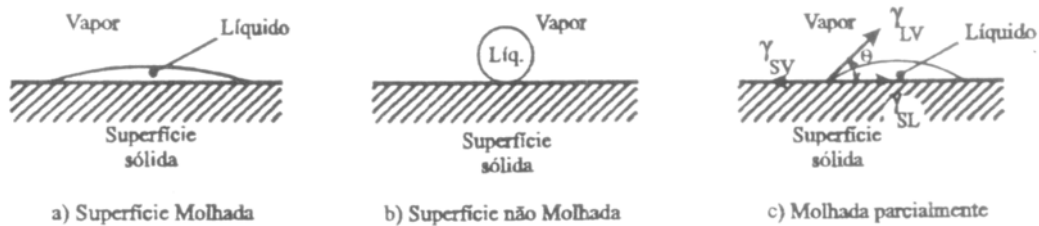
Figura 9 – Condições de molhabilidade de um líquido sobre uma superfície sólida (Gomes, 1995).
