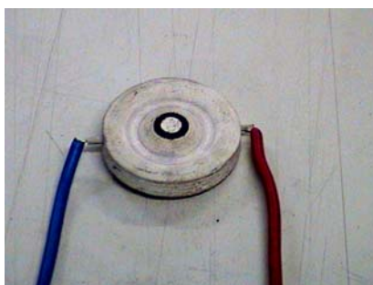
Figura 11 – Conjunto célula de reação, cápsula deformável e termopar pronto para a execução da calibração da temperatura.
