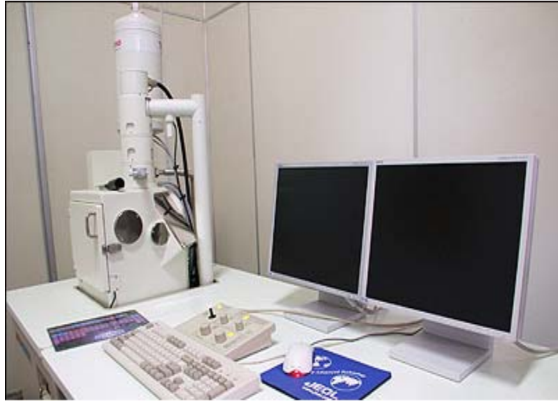
Figura 3.3 – Microscópio Eletrônico de Varredura utilizado neste trabalho.
