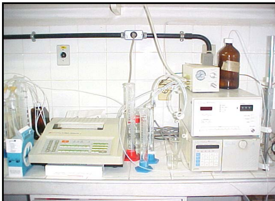
Figura 17. Aparelho de HPLC com detecção eletroquímica. Laboratório de Neurofarmacologia do Departamento de Fisiologia e Farmacologia - UFC
