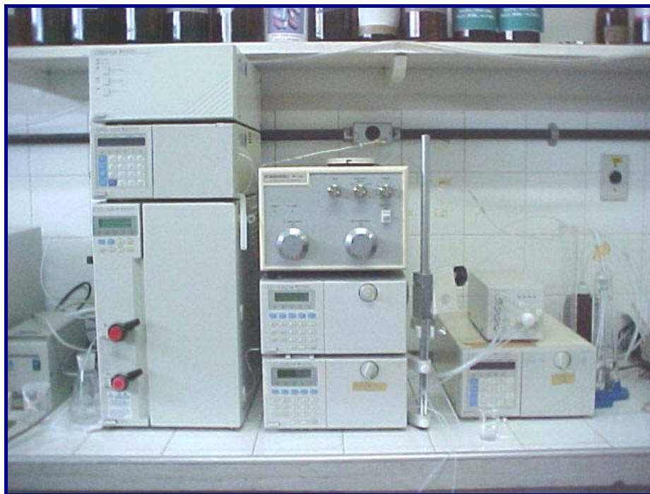
Figura 19. Aparelho de HPLC com detecção de fluorescência. Laboratório de Neurofarmacologia do Departamento de Fisiologia e Farmacologia – UFC
