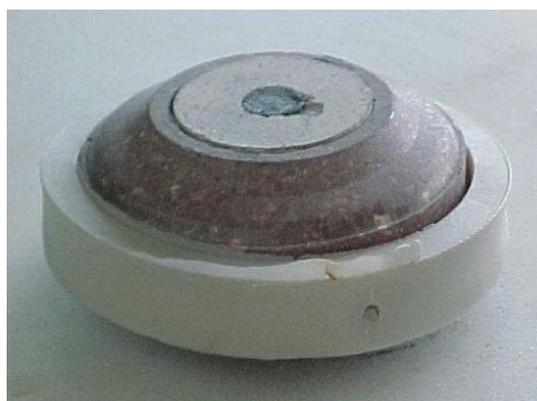
Figura 25. Cápsula montada com anel de PVC.
