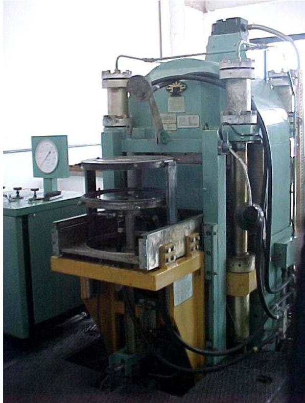
Figura 21. Prensa hidráulica especial de 2500 t.
