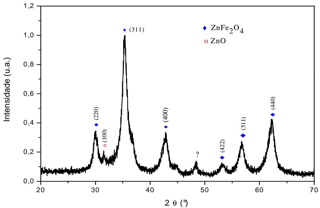
**Figura 4.9:** Precursores moídos em alta energia por 9 horas.
