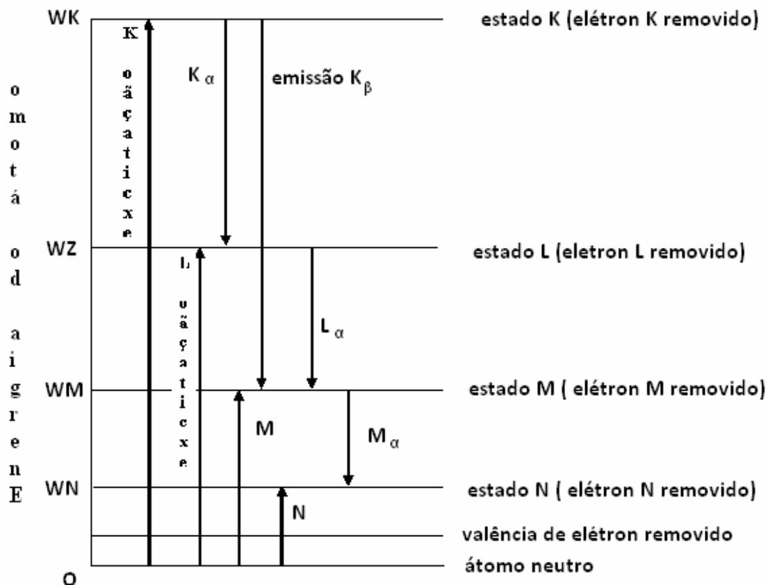
**Figura 3.10:** Níveis de energia atômico, processo de emissão e excitação (CULLITY, 1956)
