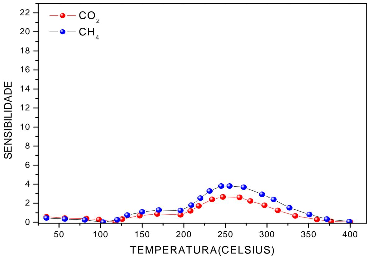
**Figura 4.27:** Gráfico de sensibilidade versus temperatura Z3
