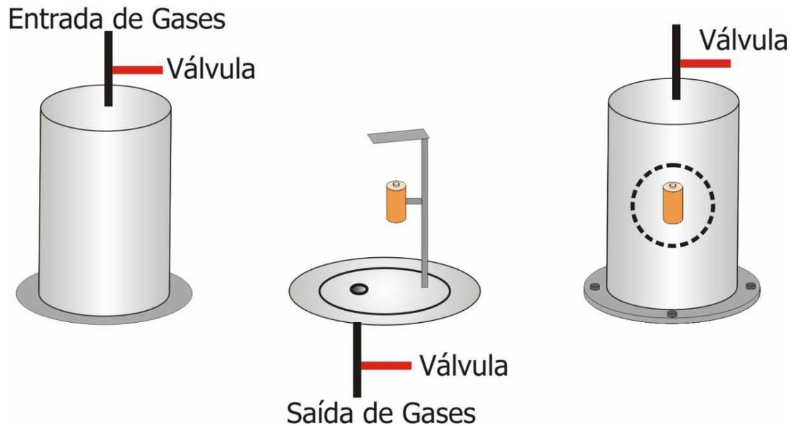
**Figura 3.13:** Cúpula, suporte metálico onde cilindro de cobre é preso e válvulas de entrada e saída de gases (POZONI, 2007).
