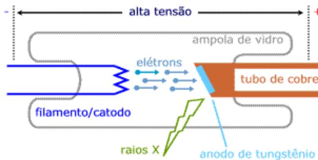
**Figura 3.6:** Tubo de geração de raios x, onde elétrons emitidos por um filamento aquecido, são acelerados por diferença de potencial até chocarem-se contra um alvo metálico <[www.mspc.eng.br](http://www.mspc.eng.br)>. Acesso em: 14 fev. 2008.
