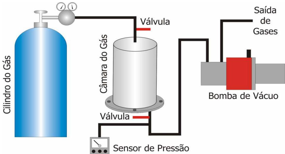
**Figura 3.14:** Conexões e válvulas que regulam a entrada e saída dos gases (PONZONI, 2007).
