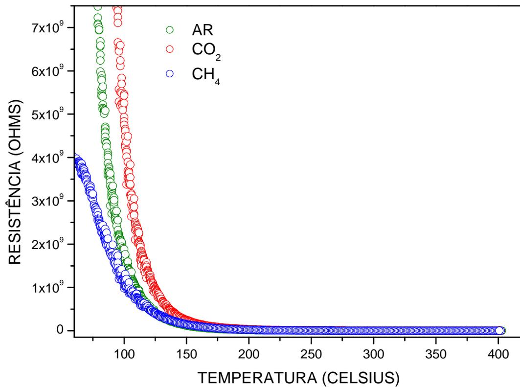
**Figura 4.28:** Medidas TER da amostra N1, em ar atmosférico e com os gases CH<sub>4</sub> e CO<sub>2</sub>.
