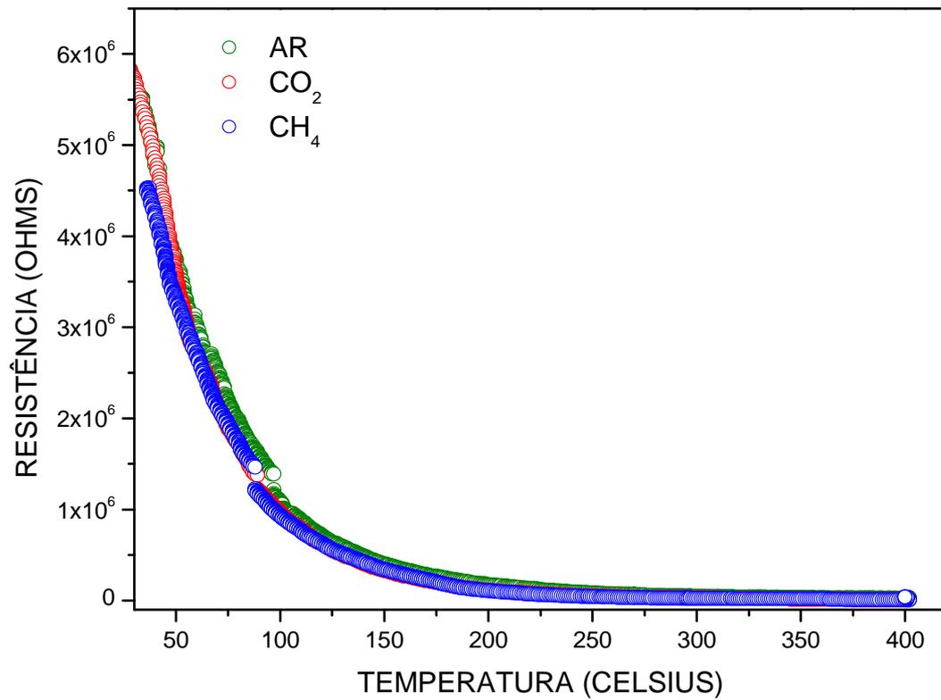
**Figura 4.30:** Medidas TER da amostra N2, em ar atmosférico e com os gases CH<sub>4</sub> e CO<sub>2</sub>.
