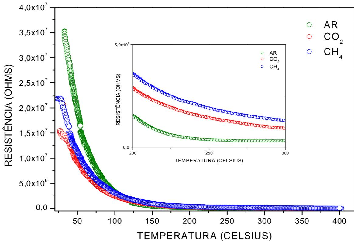
Figura 4.26: Medidas TER da amostra Z3, em ar atmosférico e com os gases CH<sub>4</sub> e CO<sub>2</sub>.
