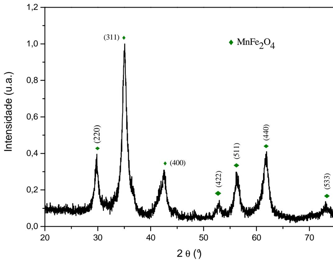
**Figura 4.4:** Precursores moídos em alta energia por 9 horas
