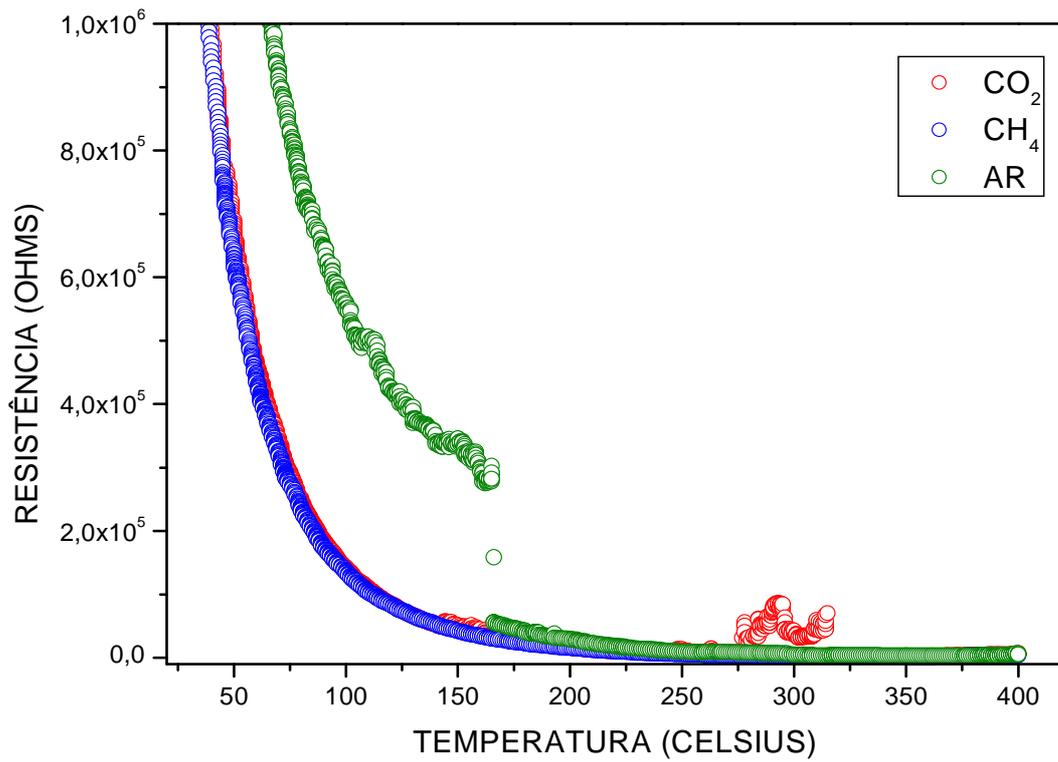
**Figura 4.16:** Medidas TER da amostra M1, em ar atmosférico e com os gases  $\text{CH}_4$  e  $\text{CO}_2$ .
