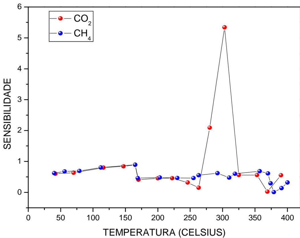
**Figura 4.17:** Gráfico de sensibilidade versus temperatura para M1
