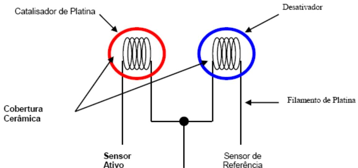
**Figura 2.4:** Esquema de um sensor catalítico (GHINI, 2002)
