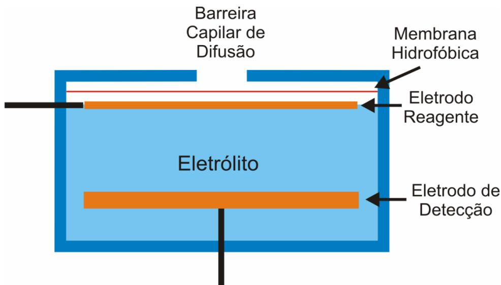
**Figura 2.1:** Esquema de um sensor eletroquímico típico.(PONZONI, 2007)
