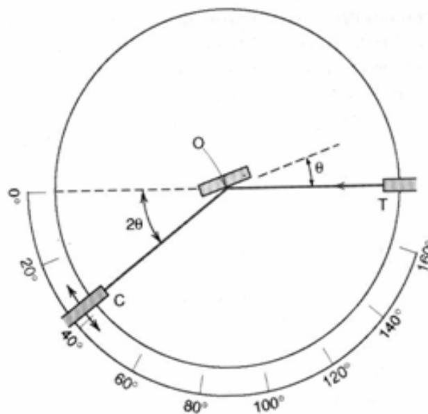
**Figura 3.7:** Diagrama esquemático de um difratômetro de raios X (CALLISTER, 2002).
