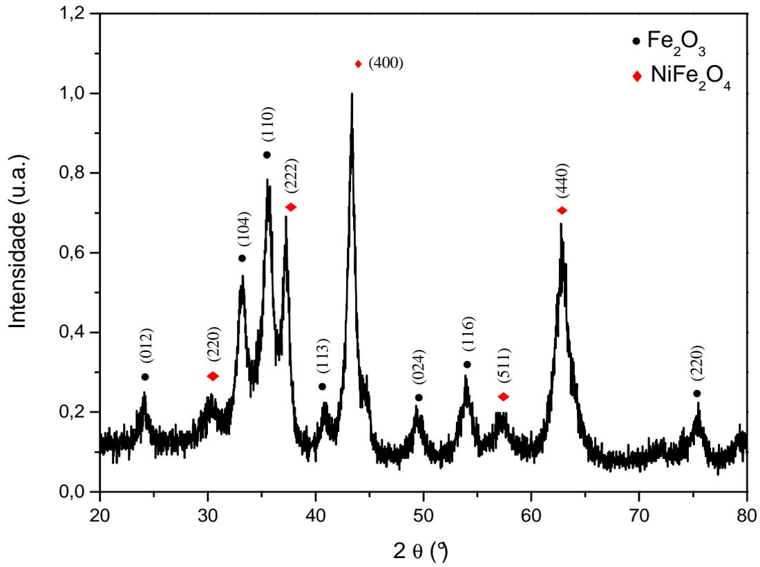
**Figura 4.13:** Precursores moídos em alta energia por 6 horas.
