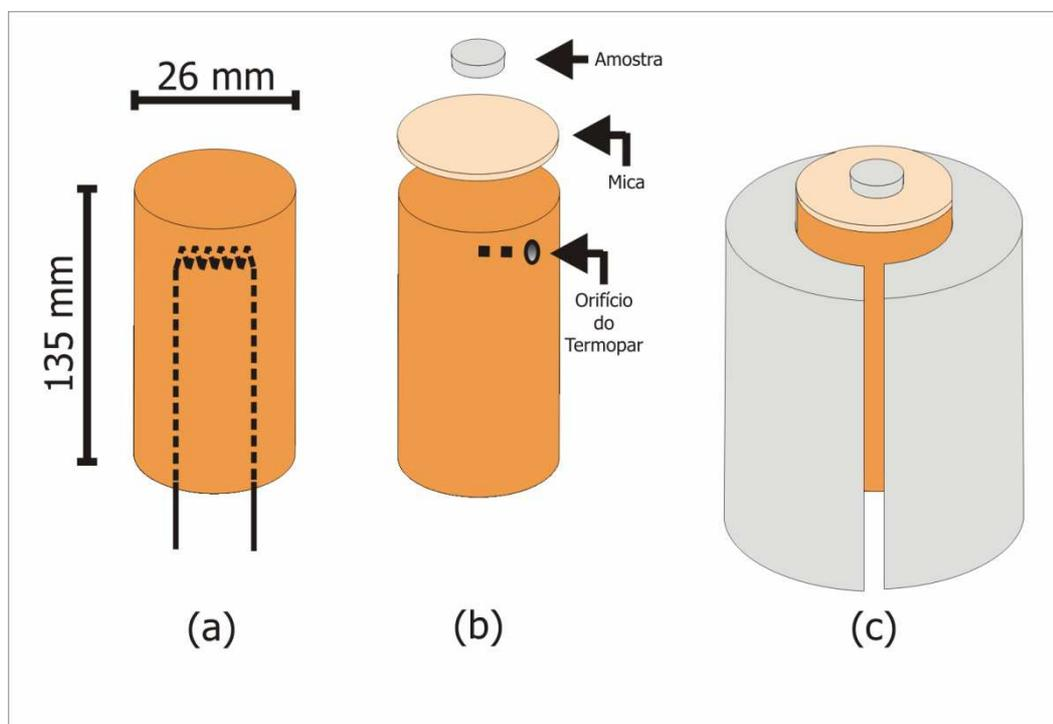
**Figura 3.11:** Ilustração do sistema utilizado para o aquecimento da amostra (a) resistência elétrica dentro do cilindro metálico; (b) lâmina de mica e orifício do termopar; (c) cilindro metálico envolto em um molde de cimento (PONZONI, 2007).
