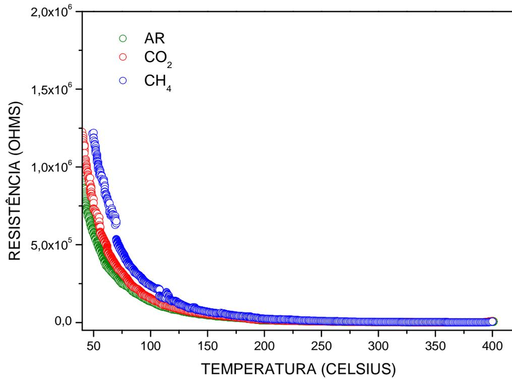
**Figura 4.20:** Medidas TER da amostra M3, em ar atmosférico e com os gases CH<sub>4</sub> e CO<sub>2</sub>.
