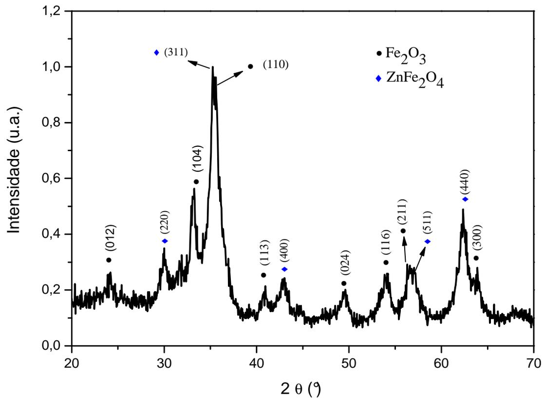
Figura 4.7: Precursores moídos em alta energia por 3 horas.
