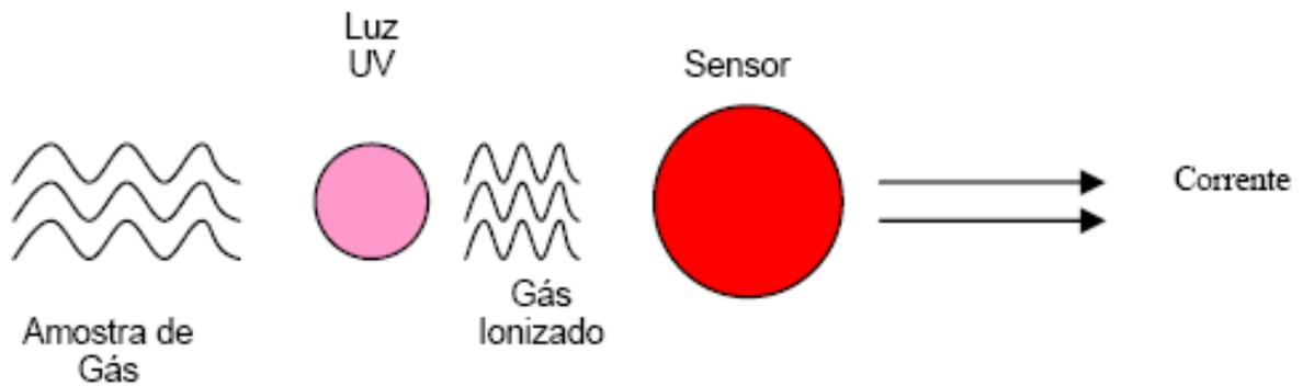
**Figura 2.5:** Esquema de um sensor fotoiônico (GHINI, 2002)
