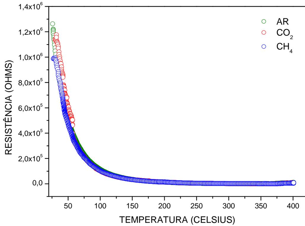
**Figura 4.18:** Medidas TER da amostra M2, em ar atmosférico e com os gases  $\text{CH}_4$  e  $\text{CO}_2$ .
