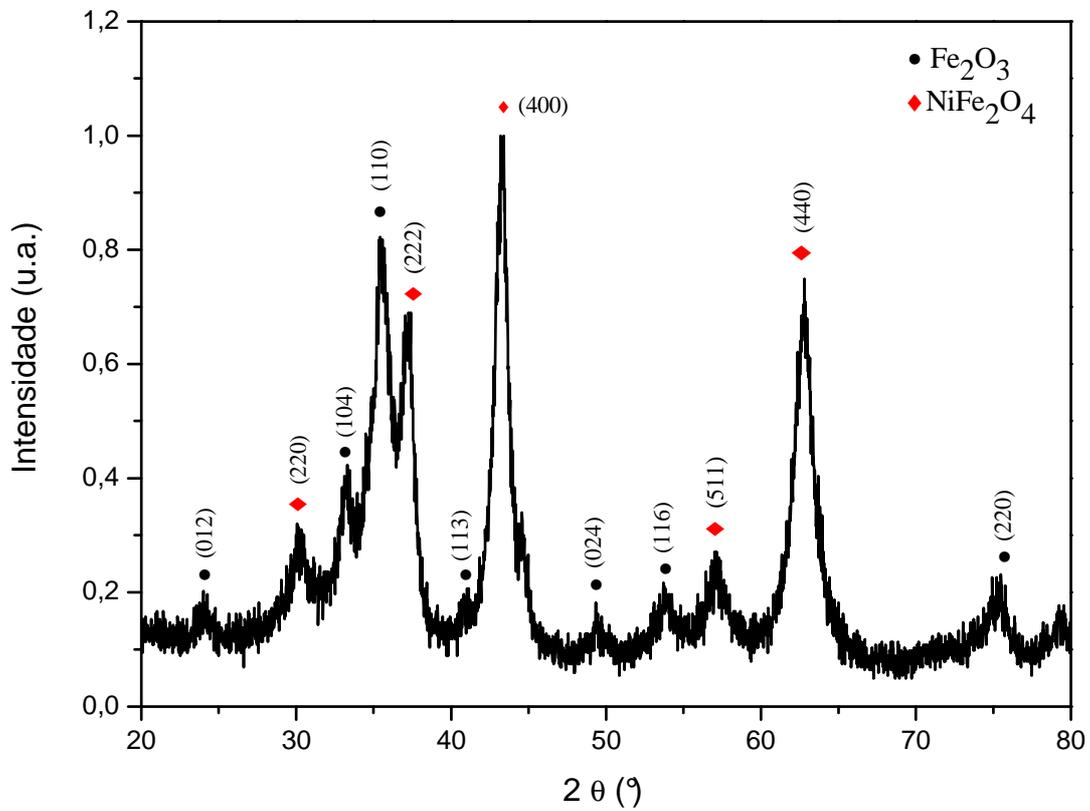
**Figura 4.14:** Precursores moídos em alta energia por 9 horas.
