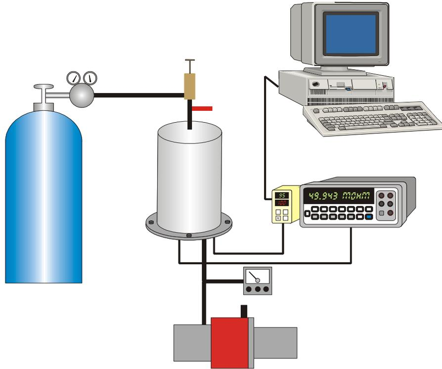
**Figura 3.15:** Sistema de aquecimento e de armazenamento de dados completo
