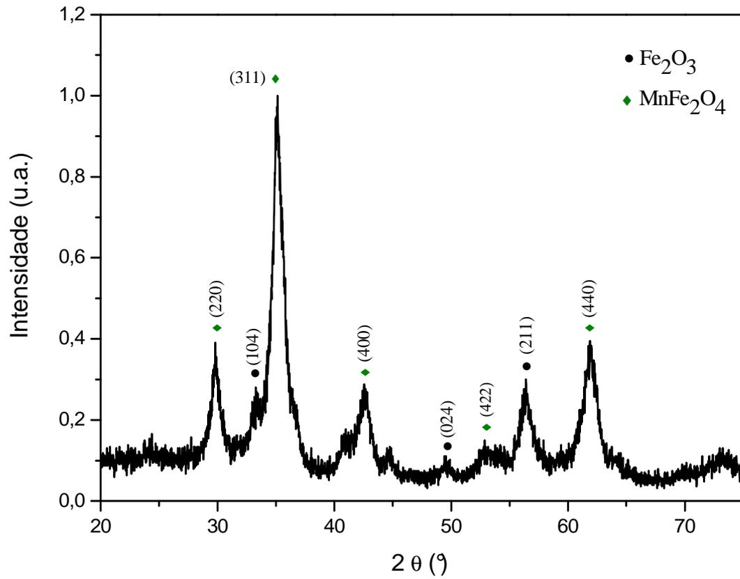
**Figura 4.3:** Precursores moídos em alta energia por 6 horas
