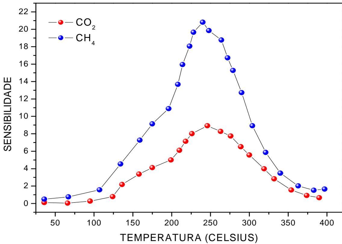
Figura 4.25: Gráfico de sensibilidade versus temperatura para Z2
