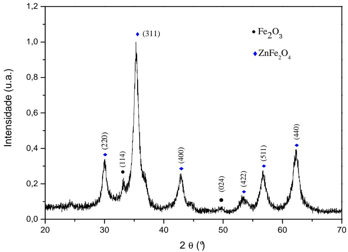
**Figura 4.8:** Precursores moídos em alta energia por 6 horas.
