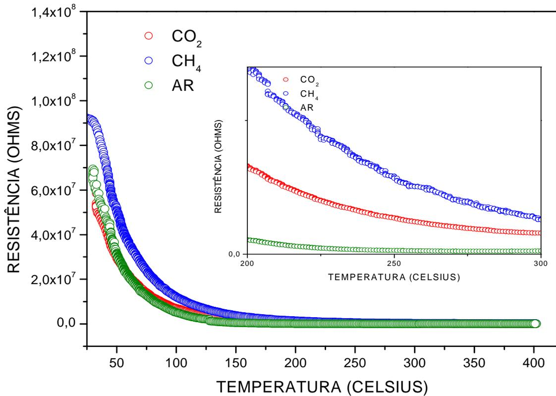
**Figura 4.24:** Medidas TER da amostra Z2, em ar atmosférico e com os gases CH<sub>4</sub> e CO<sub>2</sub>.
