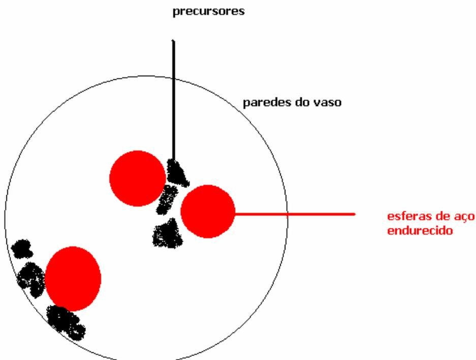
**Figura 3.1:** Ilustração de moagem no interior de um vaso em um moinho de alta energia.
