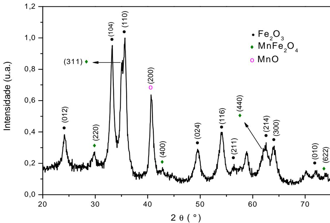
**Figura 4.2:** Precursores moídos em alta energia por 3 horas
