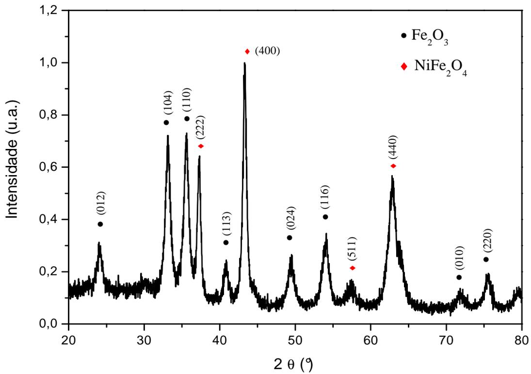
Figura 4.12: Precursores moídos em alta energia por 3 horas.
