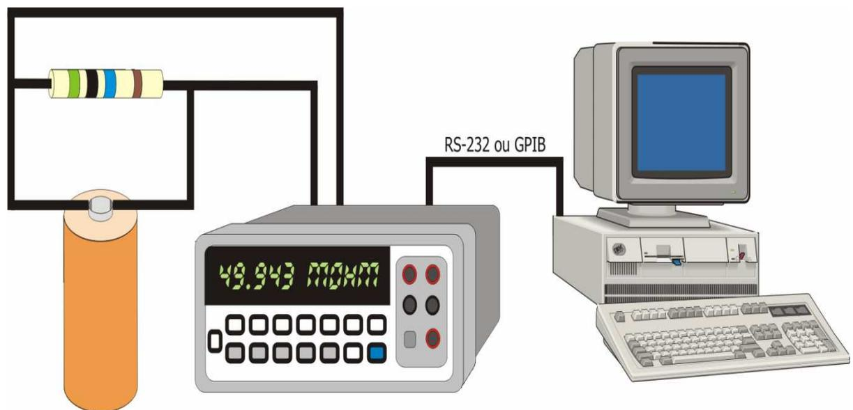
**Figura 3.12:** Ilustração dos sistema de aquecimento com a resistência em Paralelo (PONZONI, 2007)
