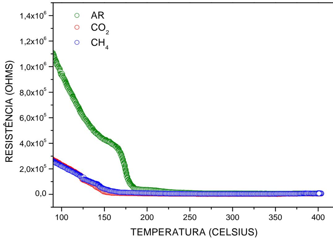
**Figura 4.32:** Medidas TER da amostra N3, em ar atmosférico e com os gases CH<sub>4</sub> e CO<sub>2</sub>.
