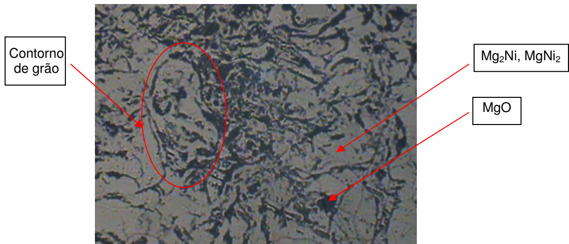
Figura 59 – Micrografia típica para uma amostra de índice 33 em 400X de aumento.
