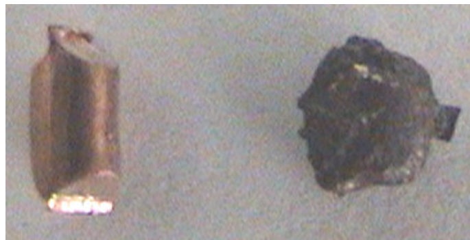
Figura 47 – Amostra de cobre (Cu) antes e após a fusão.
