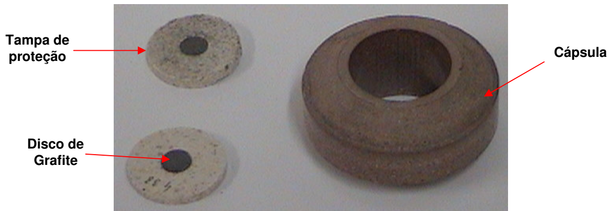
Figura 27 – Cápsula deformável e seus respectivos componentes.
