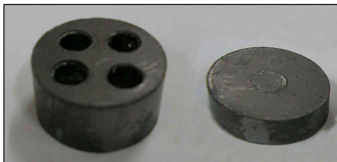
Figura 44 – Forno aquecedor e tampa fabricados à base de grafite: forno com 30 mm de diâmetro e 14 mm de altura; tampa com 30 mm de diâmetro e 10 mm de altura.
