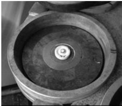
Figura 34 - DAP bigorna com concavidade toroidal contendo a célula reativa.
