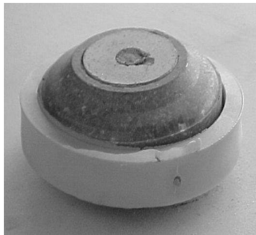
Figura 25 - Cápsula montada com anel de PVC.
