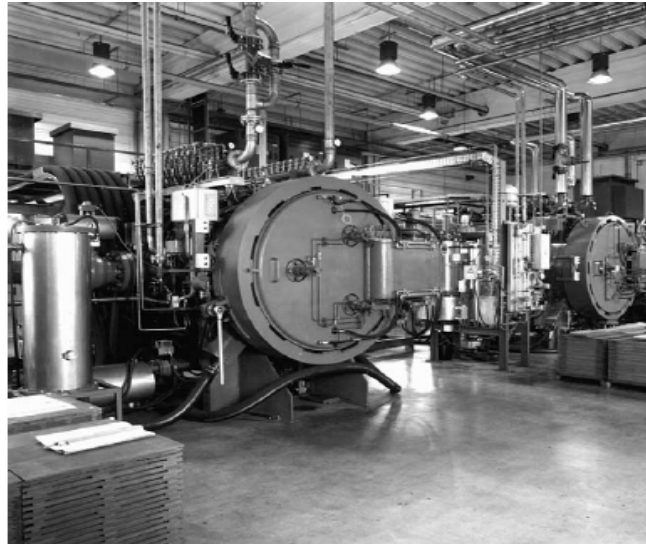
Figura 12 - Fotografia de um forno HIP [Tweed, 2003].
