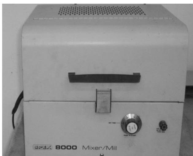
Figura 30 – Moinho de alta energia, SPEX 8000.
