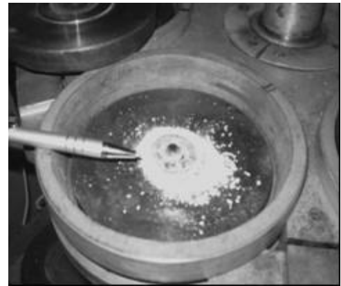
Figura 35 - Deformação da cápsula de calcita após a sinterização HPHT.
