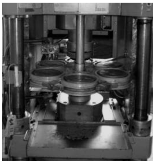
Figura 33 - Prensa Industrial 630 toneladas.
