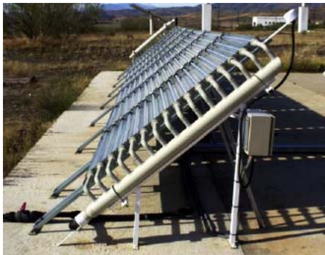
Figura 2.5. Coletores parabólicos desenvolvidos para aplicação fotocatalítica.
