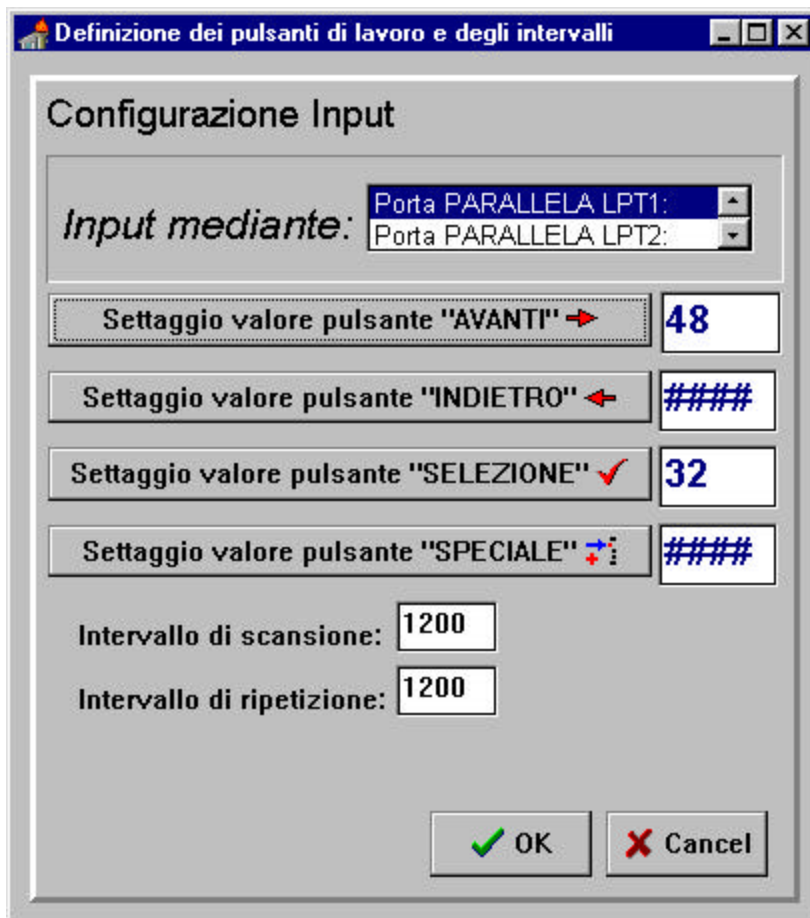
Figura 2: tela de configuração da velocidade de utilização e qual a saída a ser utilizado!
