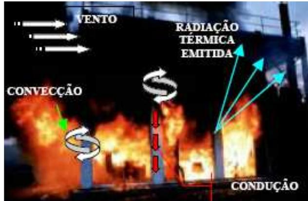
**Figura 2.7 – Mecanismos de transferência de calor em uma estrutura sob incêndio**
