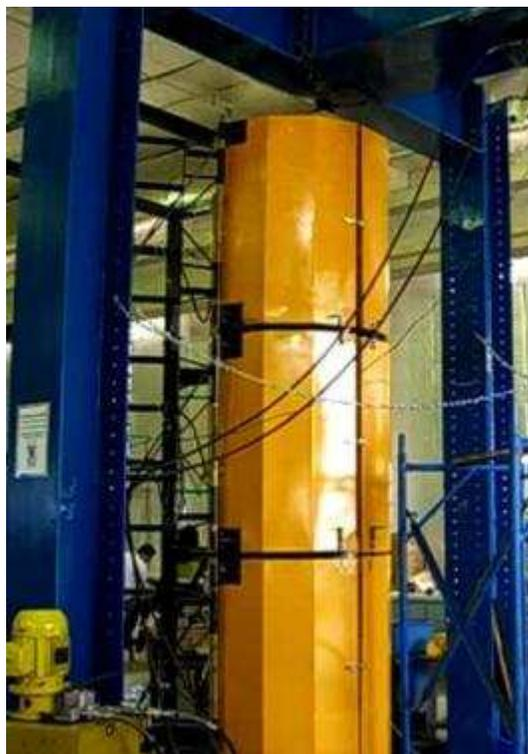
**Figura 7.2 – Forno Vertical Forno Vertical para ensaio de pilares
