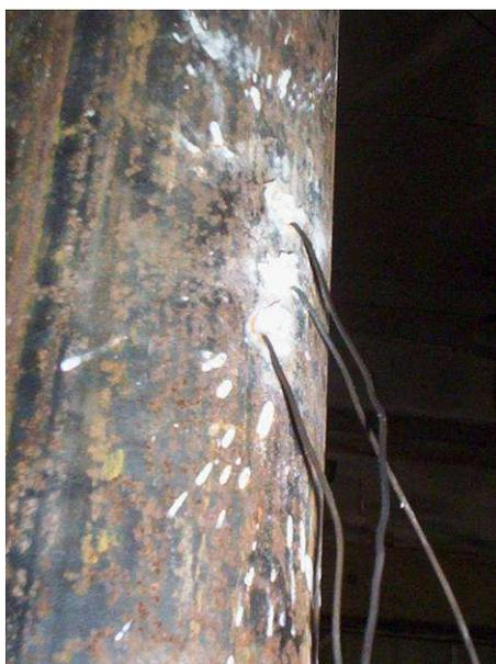
**Figura 8.33 – Posicionamento dos Termopares na Amostra**
