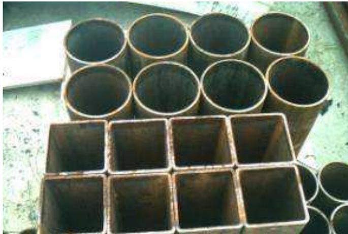
**Figura 7.10 – Posicionamento das amostras para concretagem**
