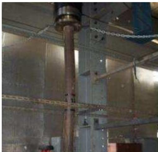
**Figura 8.3 – Ruptura das amostras por instabilidade global. RT-T114-C25-1 à esquerda e, RT-T114-C25-2 à direita**
