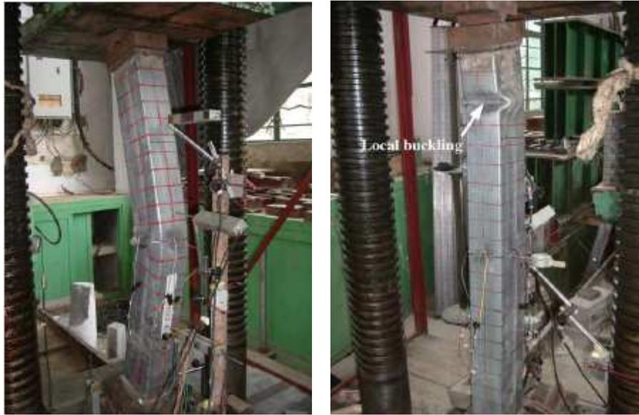
**Figura 5.3 – Ruptura típica das amostras**
