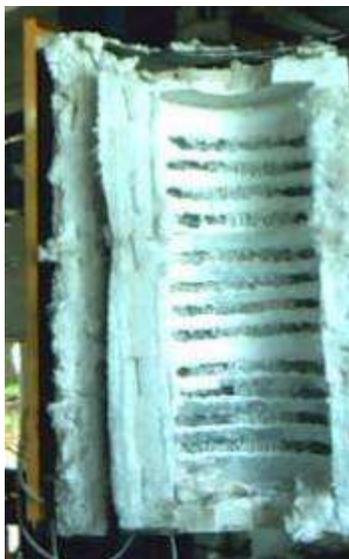
**Figura 7.4 – Módulo interno do forno**
