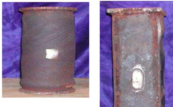
**Figura 6.4 – Modo de ruptura típico das amostras ensaiadas**
