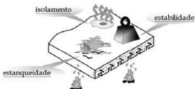
**Figura 2.11 – Mecanismos de resistência ao fogo de um elemento de compartimentação**
