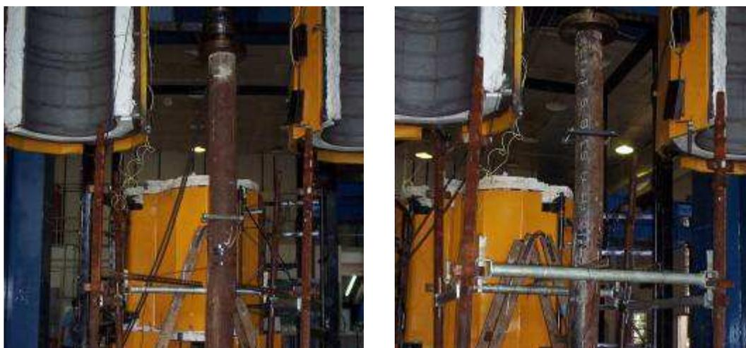
**Figura 8.5 – Ruptura das amostras por instabilidade global. RT-T168-C25-1 à esquerda e, RT-T168-C25-2 à direita**
