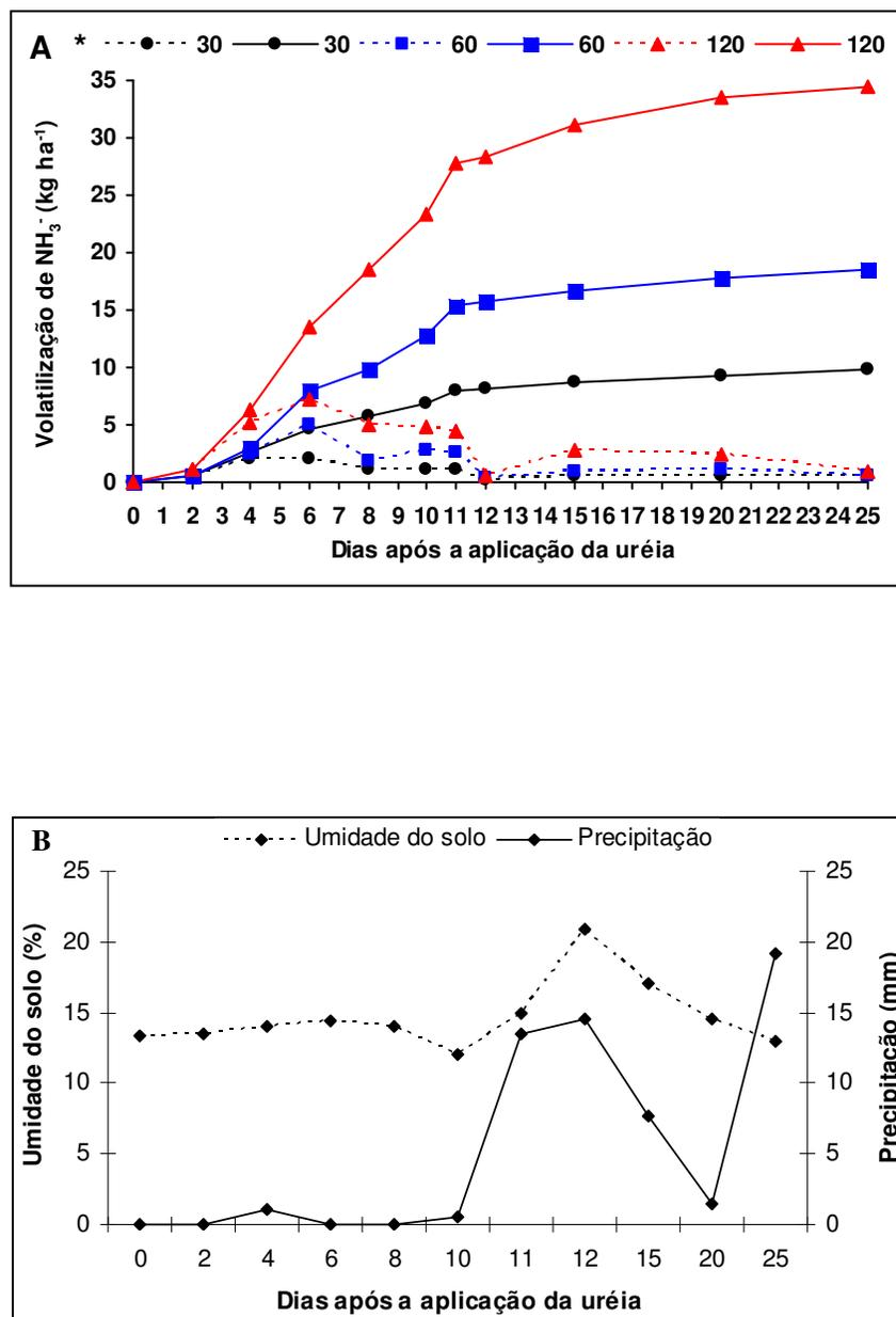
Figura 26. Perda de N por volatilização de NH<sub>3</sub> (A) em função de doses de N na safrinha 2007; umidade do solo e precipitação pluvial (B) durante o período de avaliação. \* Doses de N (kg ha<sup>-1</sup>), --- perda de NH<sub>3</sub> em cada avaliação e — perda de NH<sub>3</sub> acumulada.
