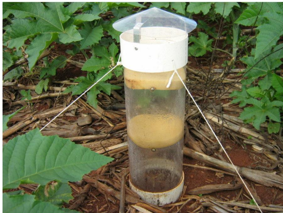
Figura 2. Coletor da NH<sub>3</sub> volatilizada da uréia.
