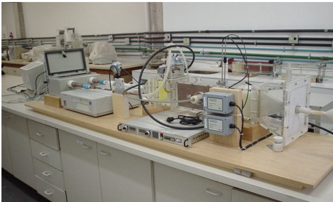
Figura 3.13 – Vista geral do CCE após automação.
