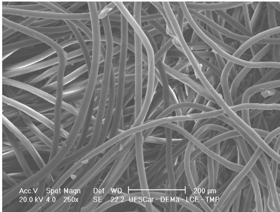
Figura 3.23 – Fotografia do feltro de polipropileno obtida no microscópio eletrônico de varredura, ampliação de 250x.
