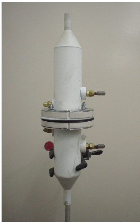
Figura 3.22 – Fotografia do suporte de filtração.
