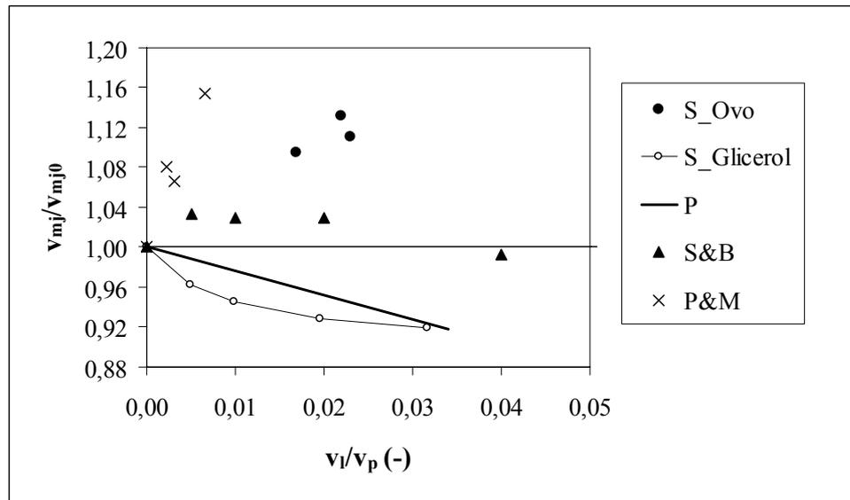
**Figura 2.10** -  $v_{mj}/v_{mj0}$  em função de  $v_l/v_p$ . S: Spitzner Neto (2002); P: Patel *et al.* (1986); S&B: Schneider e Bridgwater (1993) e P&M: Passos e Mujumdar (2000).
