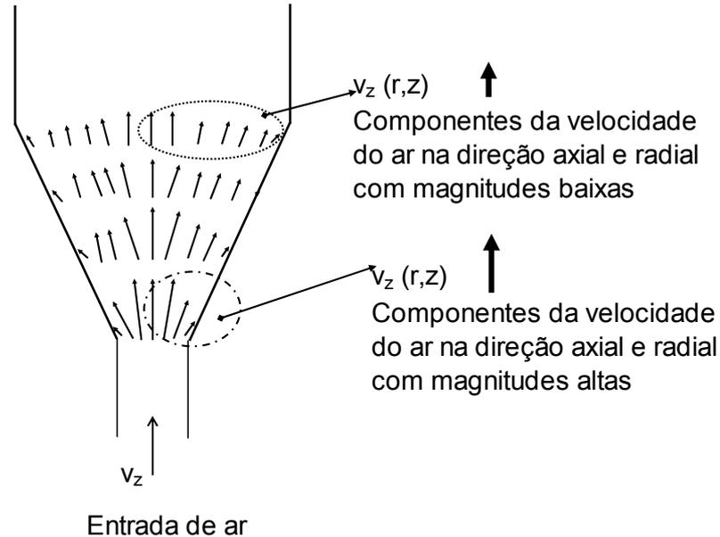
**Figura 4.8** – Representação esquemática dos mapas de velocidade do ar para leitos de jorro cônicos, San José *et al.* (1995)
