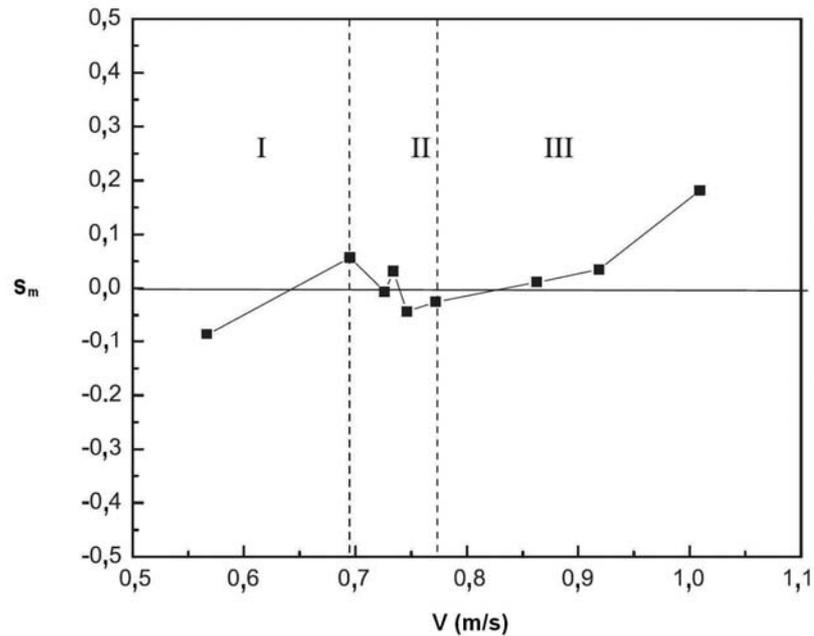
**Figura 2.4** - Assimetria da flutuação do sinal de queda de pressão total ( $s_m$ ) medida na posição 1-4 do leito em função da velocidade do ar ( $v$ ) para vários regimes de escoamento. I - leito fixo; II - jorro estável; III - jorro instável. Leito de jorro cilíndrico com as seguintes especificações:  $D_c = 120$  mm,  $H_b = 345$  mm;  $D_i = 10$  mm; esferas de vidro de  $d_p = 1,6$  mm, (Xu *et al.* 2004)
