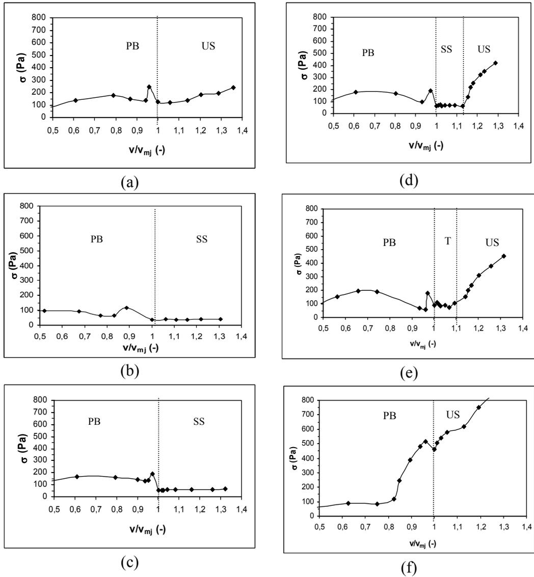
**Figura 4.2** - Desvio padrão da flutuação dos sinais de pressão ( $\sigma$ ) em um leito de partículas de composição B ( $d_s = 2,18$  mm) com na altura de leito,  $H_b = 0,195$  m, em função da velocidade do ar adimensional ( $v/v_{mj}$ ): (a)  $d_p = 1,29$  mm; (b)  $d_p = 3,67$ ; (c) referencia (isto é, monopartículas com  $d_s = 2,18$  mm); (d) mistura gaussiana; (e) mistura plana; (f) mistura binária.
