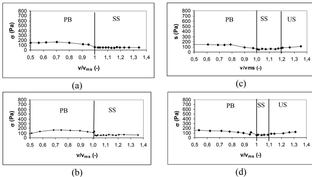
**Figura 4.3** - Desvio padrão da flutuação dos sinais de pressão ( $\sigma$ ) em um leito de partículas de composição D ( $d_s = 2,18$  mm) com altura de leito,  $H_b = 0,195$  m, em função da velocidade do ar adimensional ( $v/v_{mj}$ ): (a) referência ; (b) mistura gaussiana; (c) mistura plana; (d) mistura binária.
