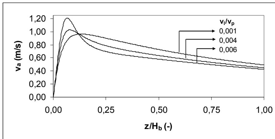
**Figura 4.17** – Perfil simulado da velocidade do ar no ânulo ( $v_a$ ) em função de  $z/H_b$  e da concentração de glicerol
