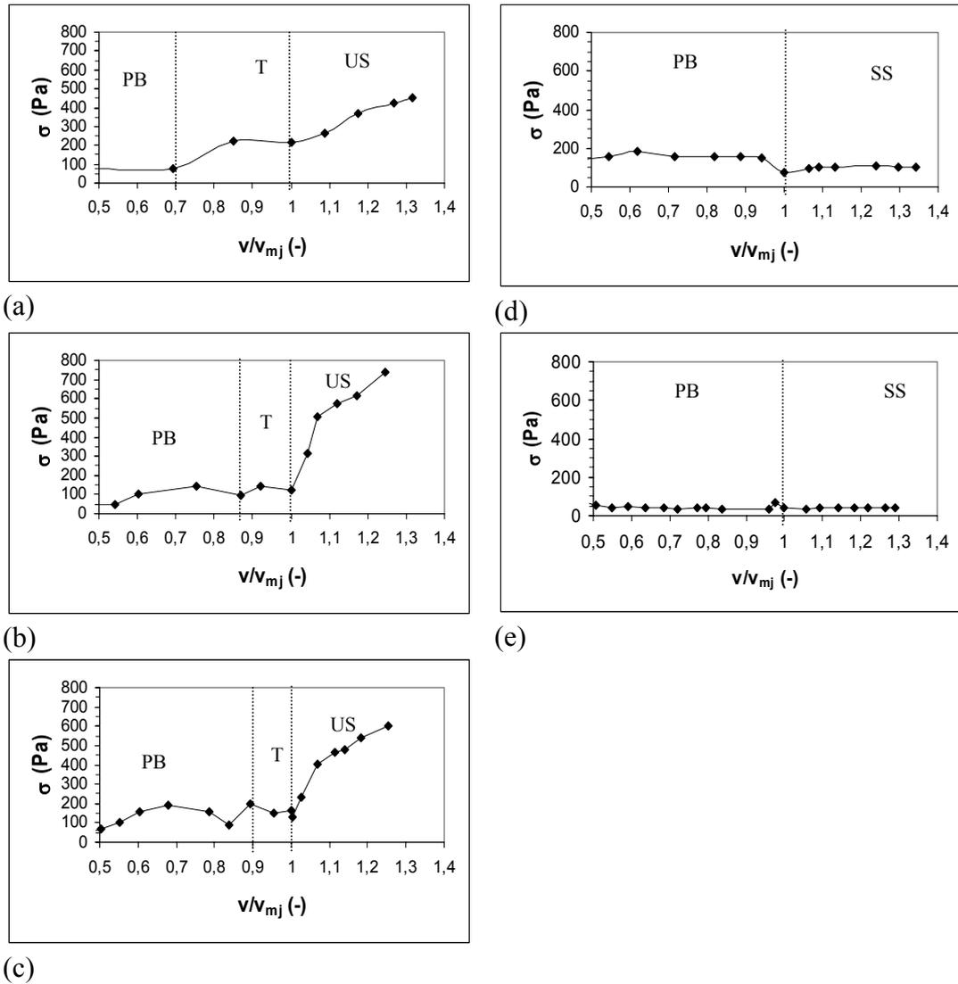
**Figura 4.1** – Desvio padrão da flutuação dos sinais de pressão ( $\sigma$ ) em um leito de partículas de composição A ( $d_s = 1,85$  mm) com altura de leito,  $H_b = 0,195$  m, em função da velocidade do ar adimensional ( $v/v_{mj}$ ): (a)  $d_p = 0,78$  mm, (b) mistura plana, (c) mistura gaussiana, (d) referência (isto é, monopartículas com  $d_s = 1,85$  mm), (e)  $d_p = 4,38$  mm.
