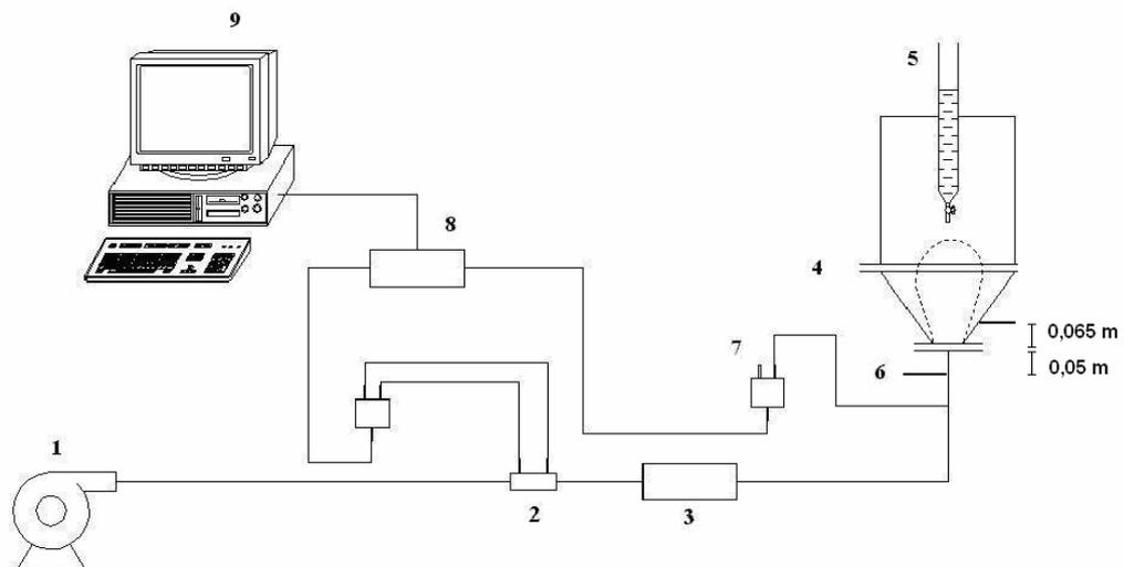
**Figura 3.1** – Aparato experimental. 1-soprador, 2-medidor de vazão Venturi, 3-aquecedor, 4-leito de jorro cônico, 5-bureta, 6- termopar, 7-transdutor de pressão, 8-placa condicionadora de sinais, 9- computador.
