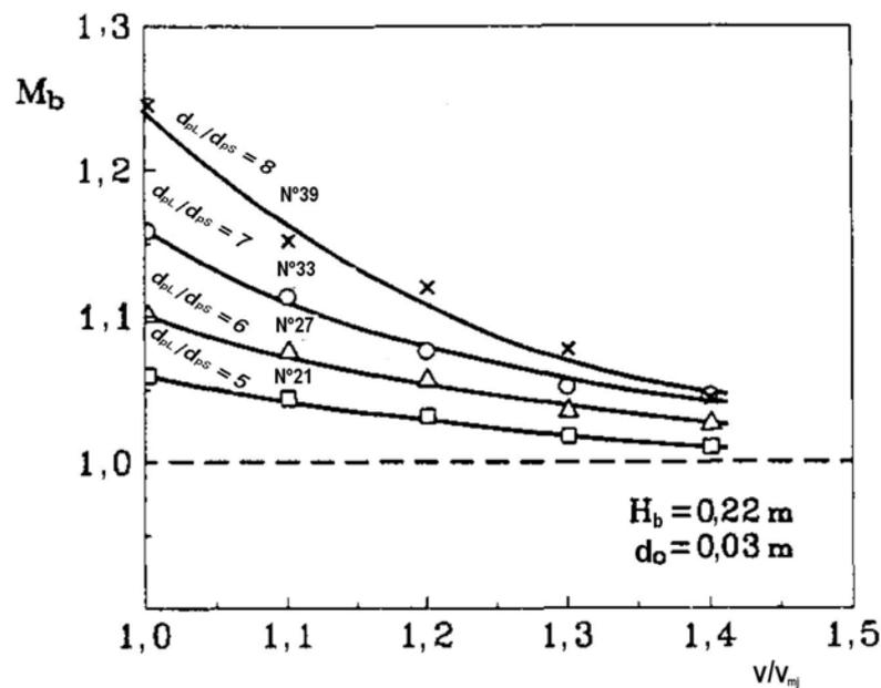
**Figura 2.6** – Índice de mistura para composição binária ( $M_b$ ) em função da velocidade do ar adimensional ( $v/v_{mj}$ ) para as diferentes razões entre os diâmetros das partículas maior e menor ( $d_{pL}/d_{ps}$ ) das misturas, San José *et al.* (1994).
