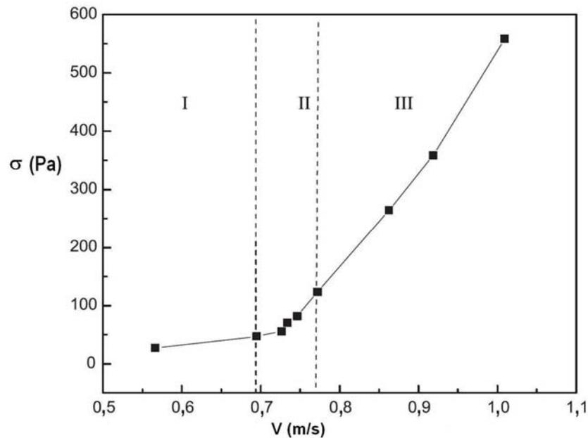
**Figura 2.3** – Desvio padrão da flutuação do sinal de queda de pressão total ( $\sigma$ ) medido na posição 1-4 do leito em função da velocidade do ar ( $v$ ) para vários regimes de escoamento. I - leito fixo; II - jorro estável; III - jorro instável. Leito de jorro cilíndrico com as seguintes especificações:  $D_c = 120$  mm,  $H_b = 345$  mm;  $D_i = 10$  mm; esferas de vidro de  $d_p = 1,6$  mm, (Xu *et al.* 2004)
