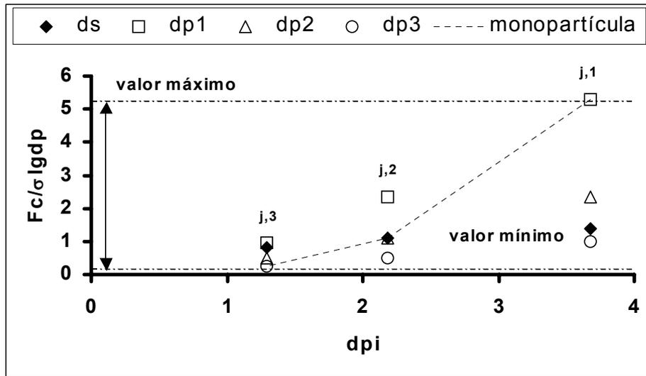
**Figura 4.9** - Estimativa dos limites do adimensional de força coesiva  $F_c/(\sigma_l g d_p)$  determinado para cada par de esferas  $d_{pi}$  e  $d_{pj}$ . Onde  $d_{pi}$  está especificado no eixo da abscissa e  $d_{pj}$  no símbolo da legenda,  $d_{p1}=3,675$  mm;  $d_{p2} = 2,18$  mm;  $d_{p3} = 1,29$  mm.
