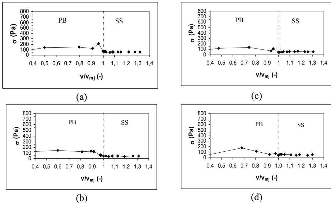
**Figura 4.4** - Desvio padrão da flutuação dos sinais de pressão ( $\sigma$ ) na altura de leito,  $H_b = 0,195$  m em um leito de partículas de composição C ( $d_s = 2,58$  mm) em função da velocidade do ar adimensional ( $v/v_{mj}$ ): (a) referência (isto é, monopartículas com  $d_s = 1,85$  mm); (b) mistura gaussiana; (c) mistura plana; (d) mistura binária.
