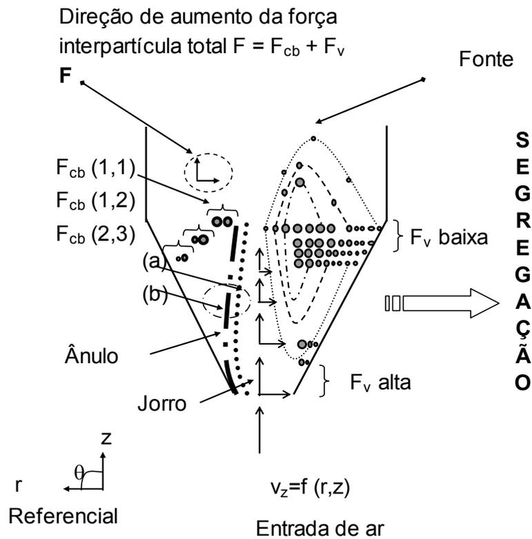
**Figura 4.7** - Esquema do leito de jorro constituído de partículas com diferente distribuição de tamanho e na presença de líquido. Partículas: (1) de maior diâmetro; (2) de diâmetro intermediário; (3) de menor diâmetro. Perfil axial do raio do jorro: (a) sem a presença de glicerol e (b) na presença de glicerol.
