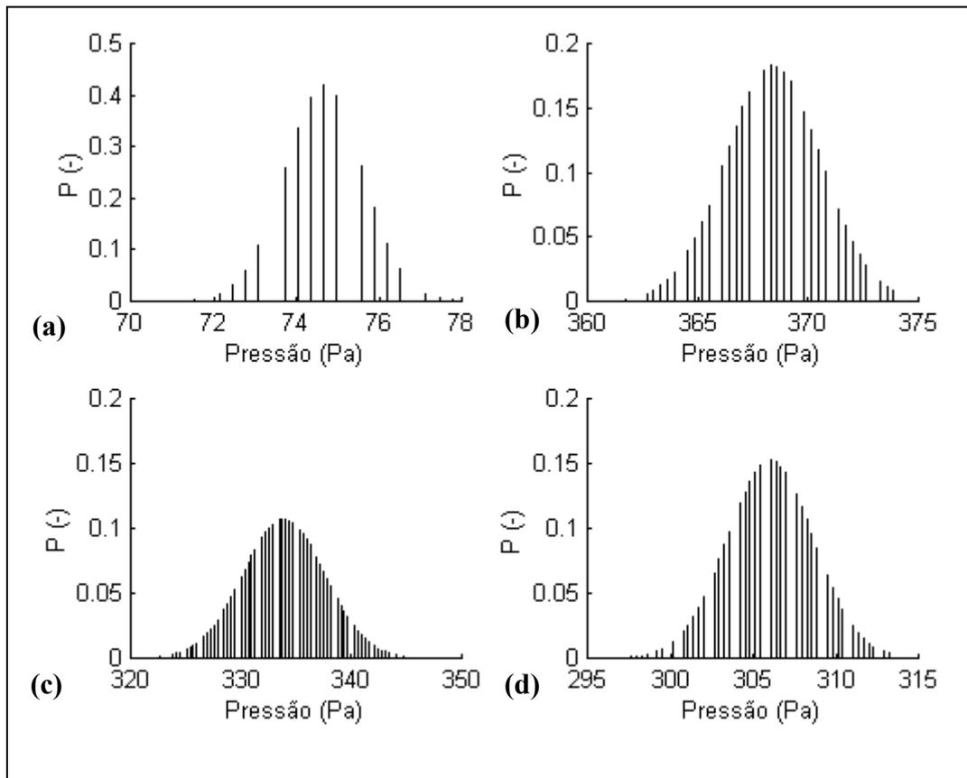
**Figura 3.3** – Distribuição de probabilidade do sinal de pressão no leito. (a) leito fixo; (b) leito fixo com jato de ar na cavidade central do leito; (c) jorro incipiente; (d) jorro. Ponto de medida de pressão na parede do leito localizado a 0,065 m da base do leito.
