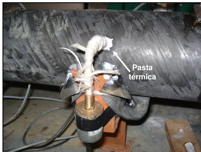
Figura 52 – Posicionamento do TCTA no corpo-de-prova e detalhe da utilização de pasta térmica.
