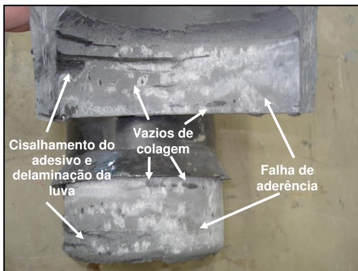
Figura 84 – Superfície de ruptura do corpo-de-prova CPE1C85.
