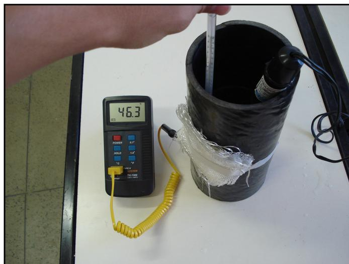
Figura 53 – Estimativa de tempo de estabilização de temperatura na parede de um setor de tubo de PRFV do fabricante nacional.
