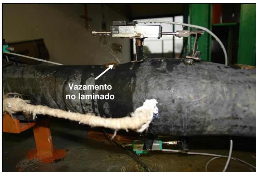
Figura 91 – Vazamento no laminado do corpo-de-prova CPE1L85.
