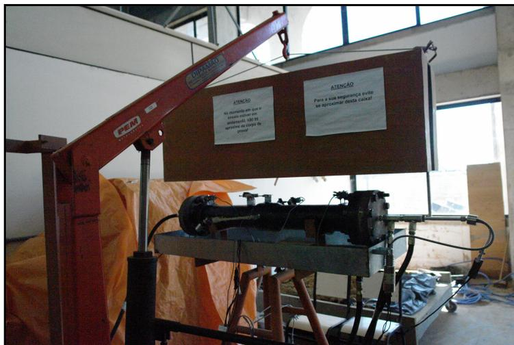
Figura 106 – Deposição da caixa protetora do corpo-de-prova.
