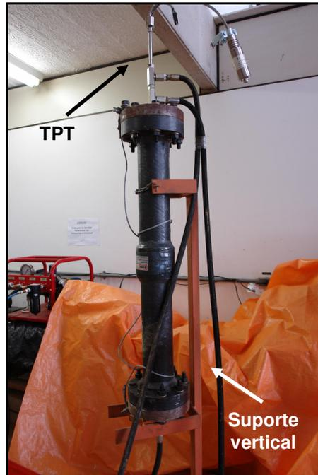
Figura 46 – Corpo-de-prova no suporte de saturação.
