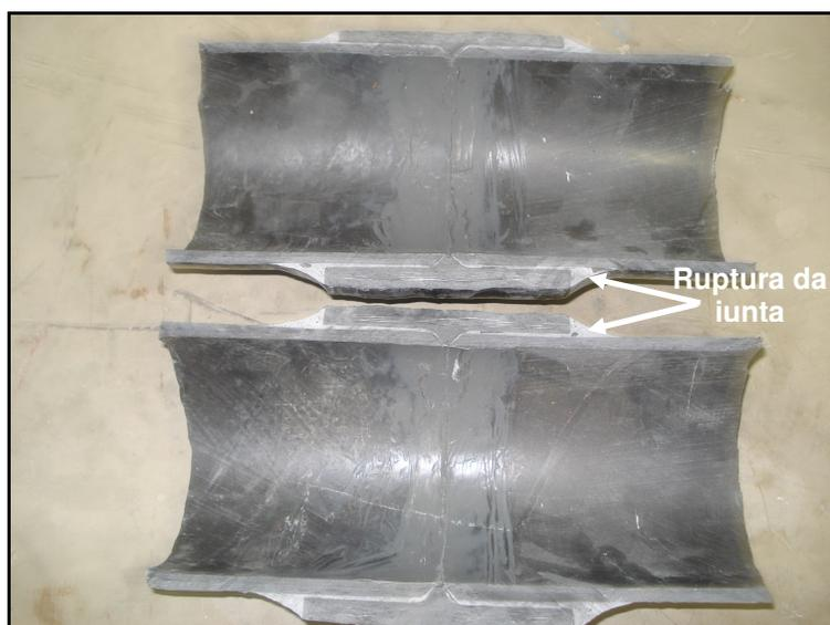
Figura 89 – Região de ruptura do corpo-de-prova CPE3C85.
