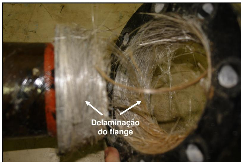
Figura 92 – Delaminação do flange no corpo-de-prova CPA1C85.
