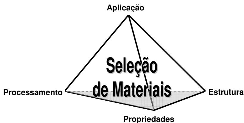
Figura 8: Da relação entre Estrutura-Propriedades-Processamento e Aplicação define-se o campo da seleção de materiais. Adaptado de Tomasi e Botta (1991).
