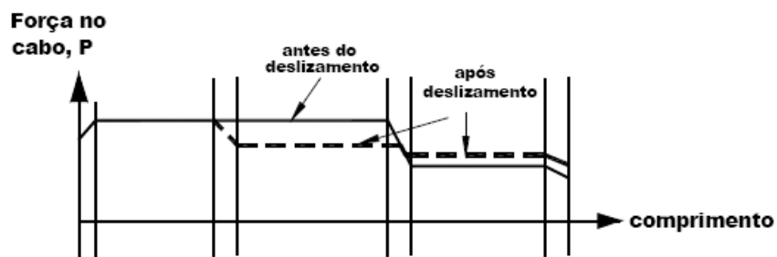
Figura 2.7 – Tensão no cabo após o deslizamento (PERLINGEIRO, 2006).
