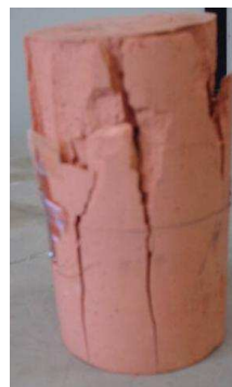
Figura 5.5 - Corpo-de-prova com diâmetro de 50 mm e temperatura de queima de 700°C após a ruptura à compressão simples.
