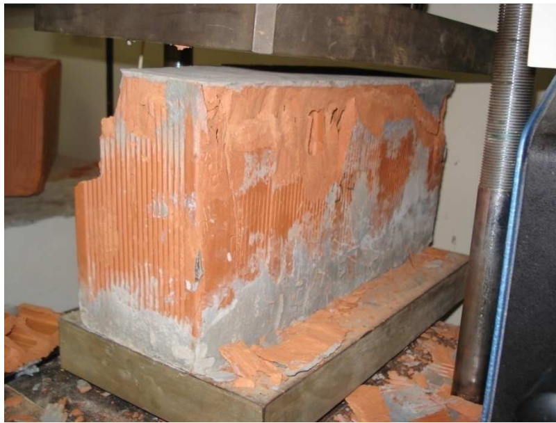
Figura 5.12 - Bloco rompido à compressão simples.
