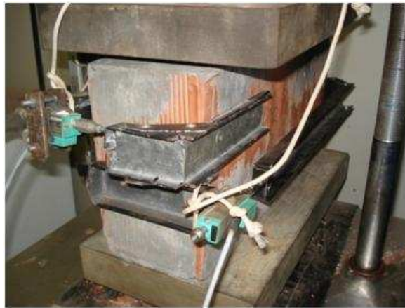
Figura 3.16 - Bloco com LVDT's fixados.
