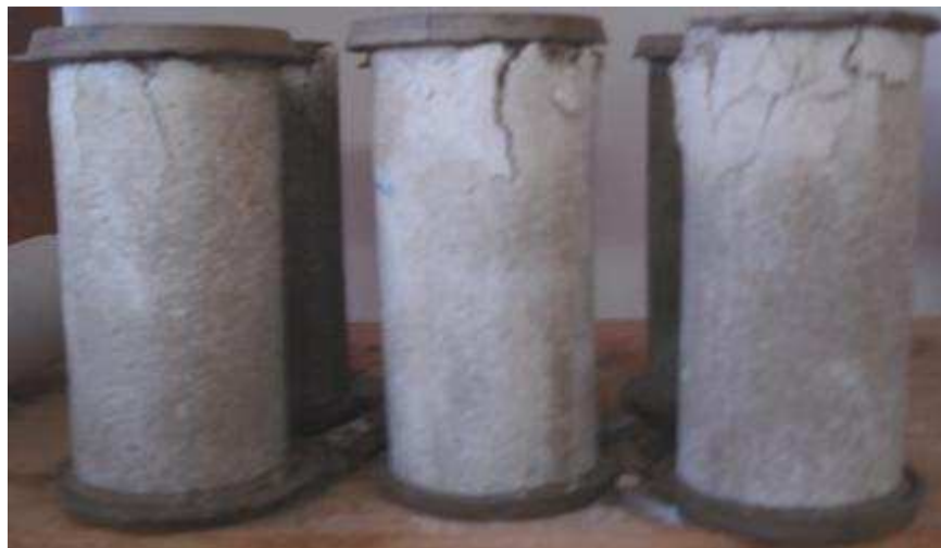
Figura 4.22 - Corpos-de-prova de argamassa
