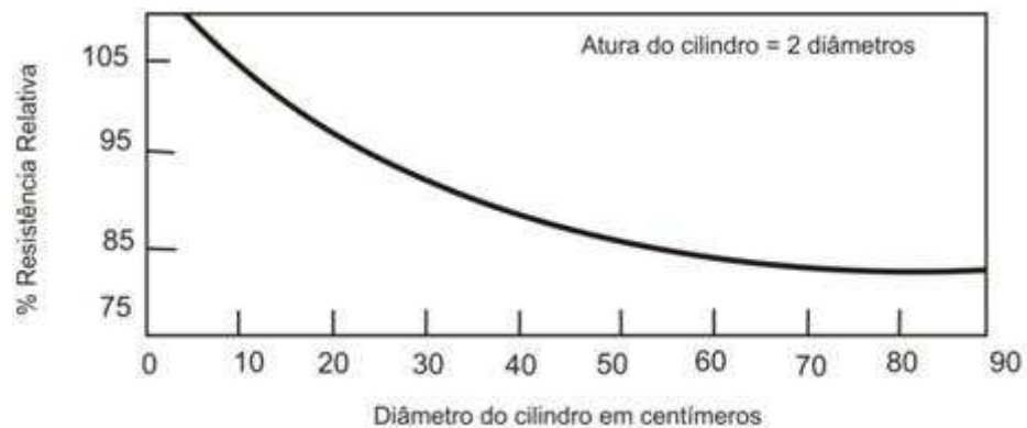
Figura 3.1 - Variação da tensão de resistência a compressão com o diâmetro do corpo-de-prova, fonte: Concrete Manual U. S. Bureau of Reclamation (1975) apud Mehta and Monteiro (1994).
