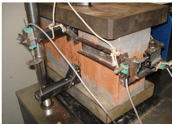
Figura 3.15 - Bloco com LVDT's fixados.
