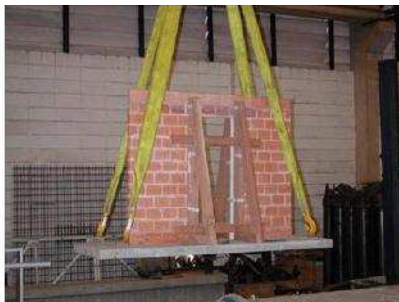
Figura 2.19 - Transporte de painel até a prensa – Fonte: Correa (2003).
