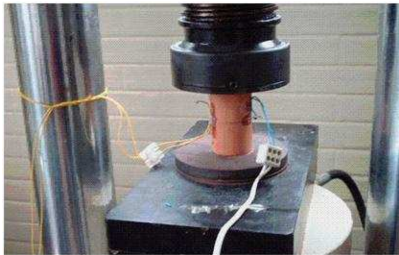
Figura 3.9 - Corpo-de-prova cerâmico (diâmetro de 6 cm) com extensômetros.
