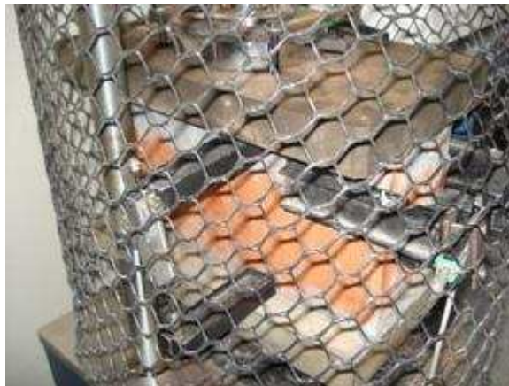
Figura 4.19 - Bloco pronto para ensaio a compressão simples.
