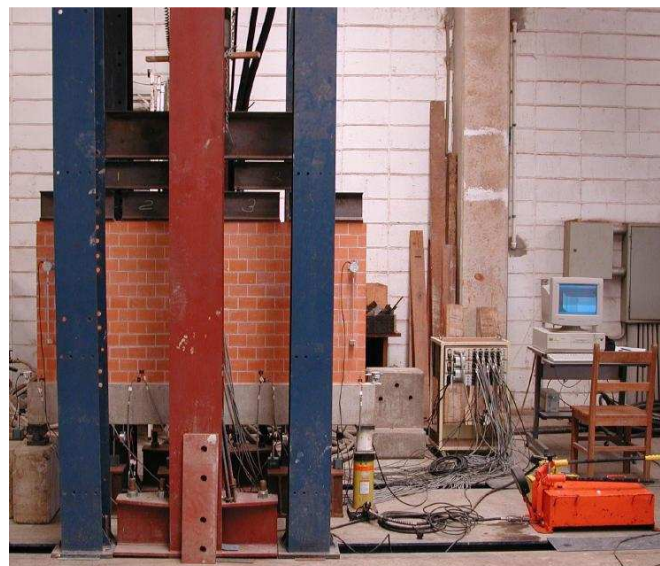
Figura 2.12 - Painel de alvenaria em escala reduzida ensaiado na prensa – Fonte: Holanda (2002).
