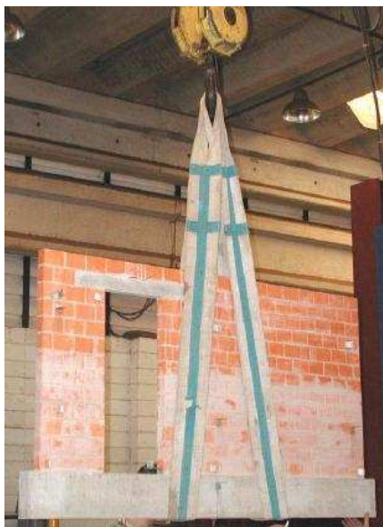
Figura 2.13 - Painel sendo transportado para a prensa – Fonte: Holanda (2002).
