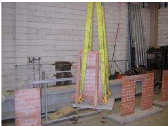
Figura 2.19 - Transporte de painel até a prensa – Fonte: Correa (2003).
