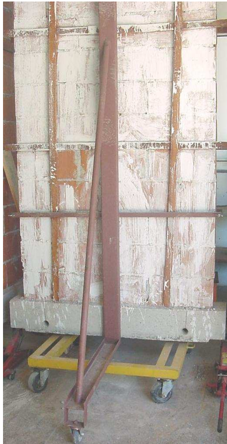
Figura 3.23 - Plataforma com alvenaria acomodada e contraventada.
