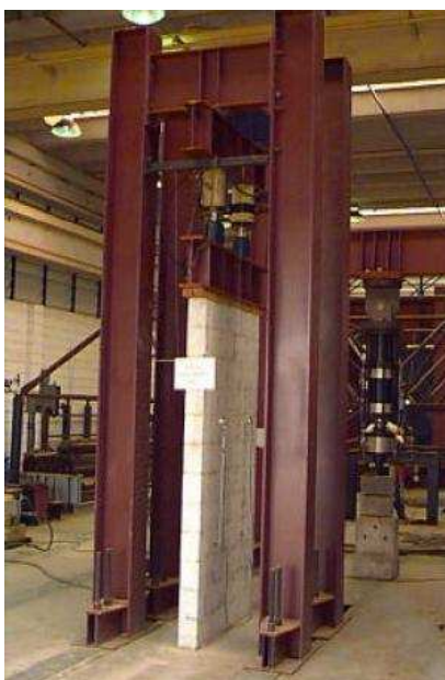
Figura 2.10 - Parede sendo ensaiada – Fonte: Garcia (2000).
