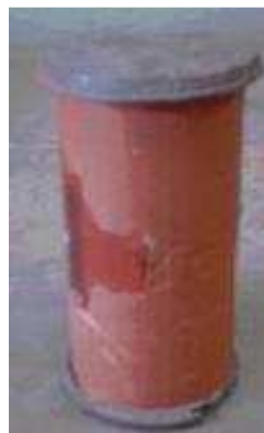
Figura 3.4 - Corpo de prova cerâmico capeado com enxofre.
