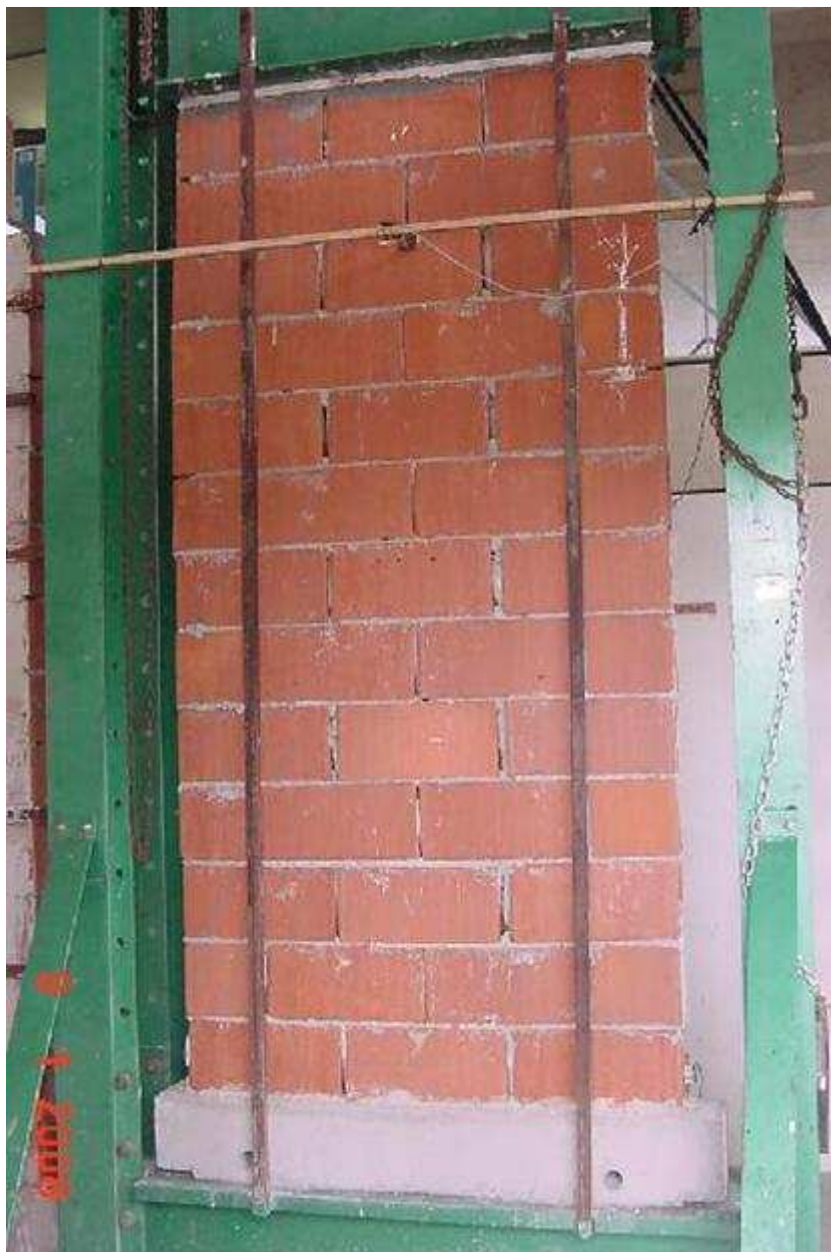
Figura 4.24 - Bloco em início de ensaio a compressão simples.
