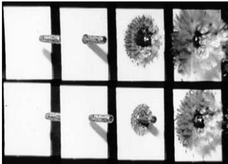
Figura 9 – Impacto de um projétil em uma blindagem cerâmica – fotografia de alta velocidade (WWW.UDRI.UDAYTON.EDU).
