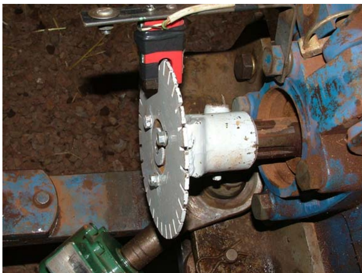
Figura 13 – Vista geral dos instrumentos utilizados para determinar a rotação no eixo do motor.
