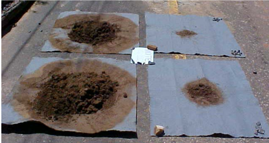
Figura 3.5. Manta de bidim que possibilitou a retenção e coleta das partículas de solo transportadas por escoamento superficial.
