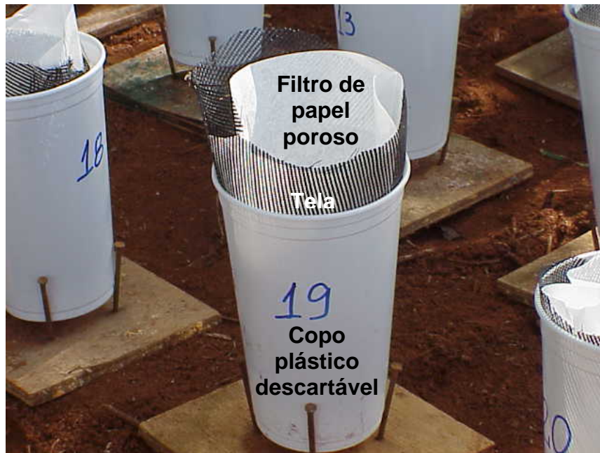
Figura 3.10. Filtro de papel poroso colocado em armação de tela e apoiado em copo de plástico descartável.
