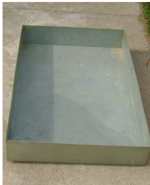
Figura 3.9. Caixa para coleta da chuva artificial para fim de avaliação da intensidade de precipitação média durante os testes.
