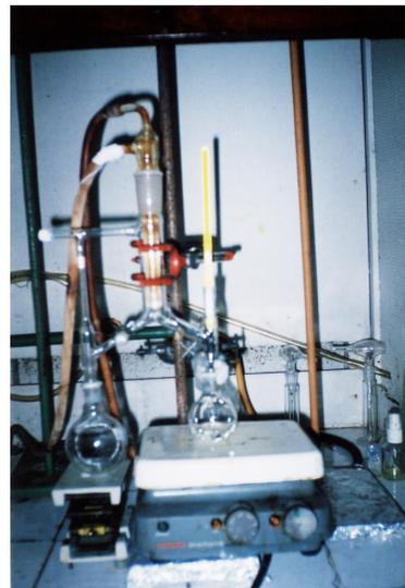
**Figura 9:** Concentração da fração de diclorometano.
