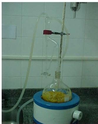
**Figura 5:** Aparelho tipo Clevenger modificado.
