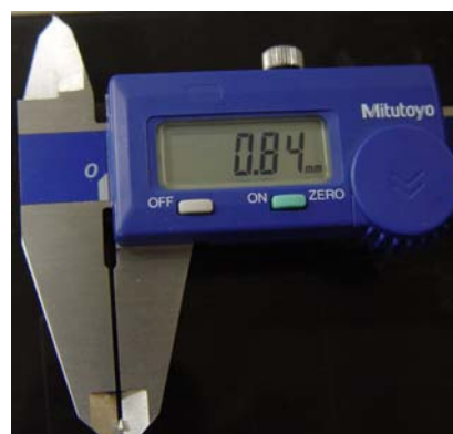
Figura 19 – Mensuração do espécime com paquímetro digital
