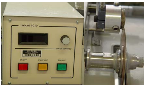
Figura 16 – Máquina de cortes Labcut 1010 (Extex corp., Enfield, CT USA) e à esq. disco de corte diamantado
