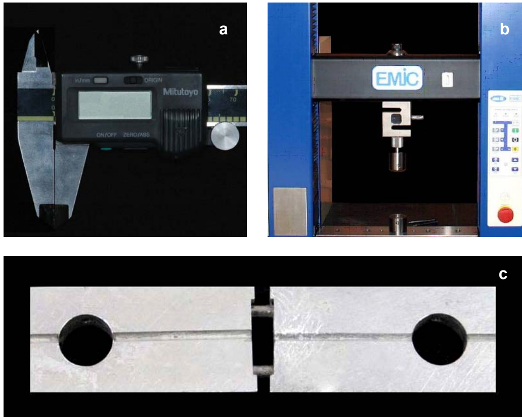
Figura 5 – Seqüência para o teste de microtração. Em (a) paquímetro digital para a medição da área dos cp; (b) máquina utilizada para o teste de microtração (EMIC); (c) garra para o teste de microtração.
