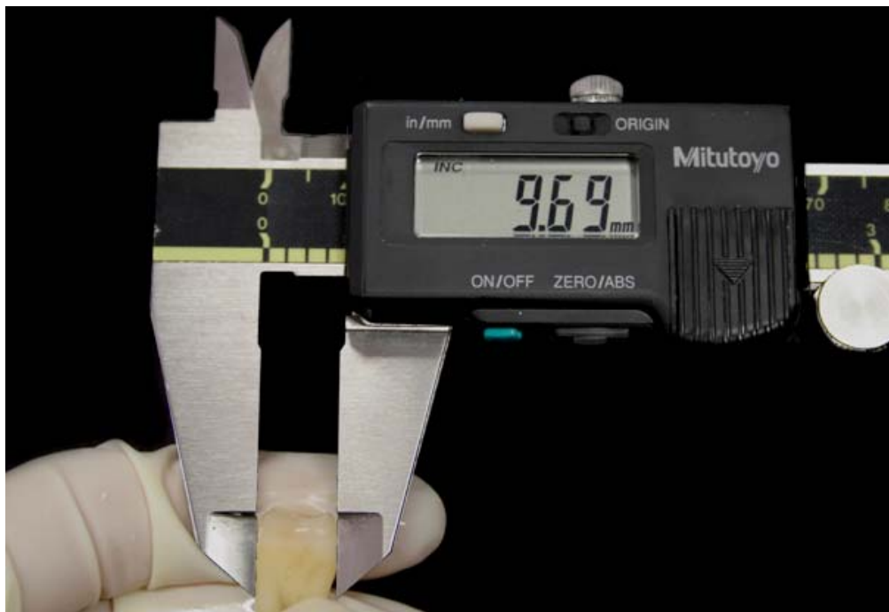
Figura 4 – Medição dos dentes com paquímetro digital
