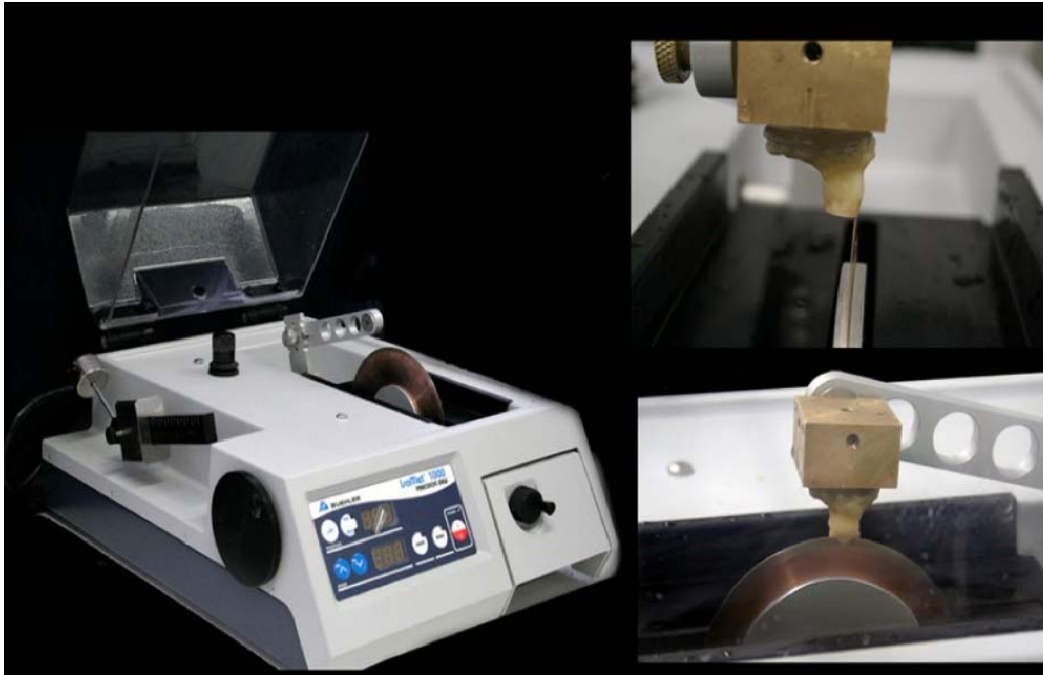
Figura 26 – Realização dos cortes para obtenção dos espécimes
