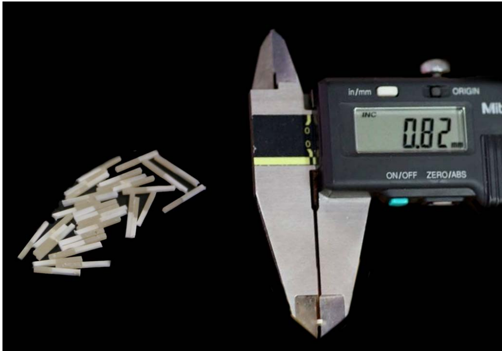
Figura 31 – Mensuração dos espécimes com paquímetro digital
