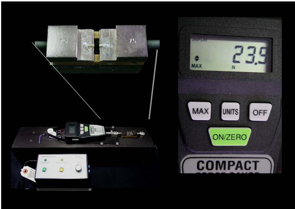
Figura 35 – Ruptura dos espécimes e tensão de tração em Newton (N)
