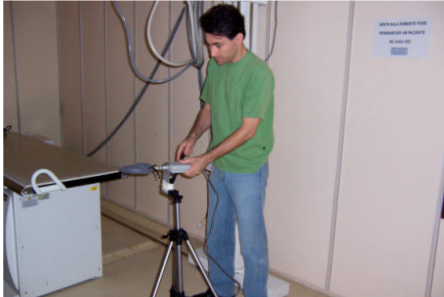
Figura 5 – Posicionamento da câmara fora da projeção da mesa bucky
