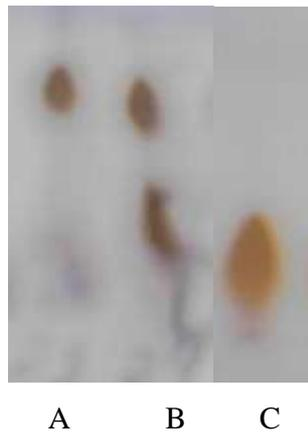
Figura 32 – Cromatografia em camada delgada dos ramnolipídeos produzidos por *P. aeruginosa* LAMI com glicerol como substrato e cultivo de 72 horas a 37 °C sob agitação de 150 rpm. A – Produto 1; B – Mistura 1 + 2; C – Produto 2.
