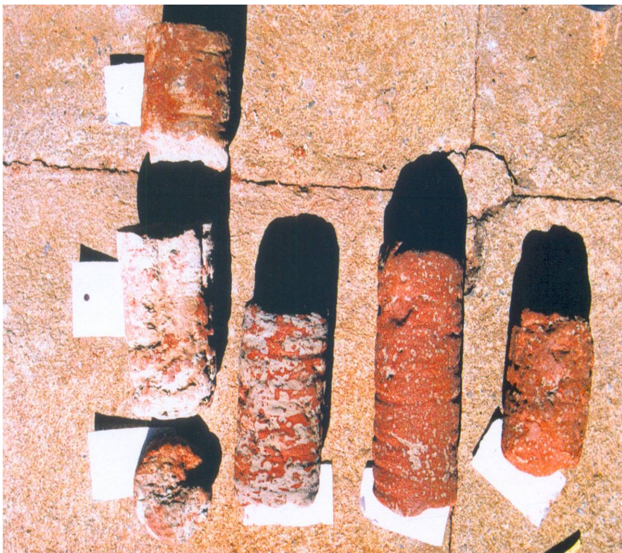
Figura37 - Testemunhos de arenitos argilosos e arenitos siltosos Fonte: Arquivo Pessoal
