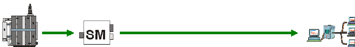
Figura 1.2 – Método utilizando sistema de medição dedicado para DGA.
